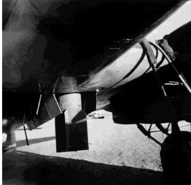
Izda.- Foto de un Heinkel He.111 B en la que se ve el puesto de ametralladora frontal, parte del cockpit y los lanzabombas ESAC/250/IX alineados de tres en tres –los terceros, apenas insinuados, se pierden por ambos laterales de la imagen-, enfrentados unos a otros. Dcha. Bomba SC.250 a medio cargar en el pozo izquierdo delantero.
