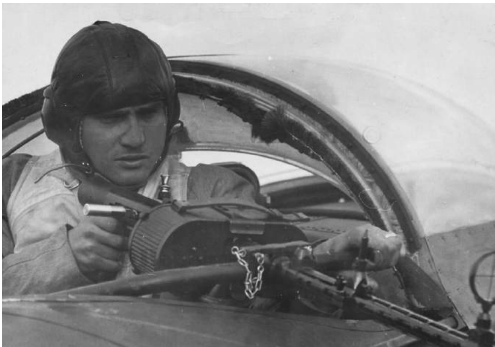
Una variante más del puesto defensivo dorsal consistente en el emplazamiento de la M.G.15 en un anillo Drehkranz D.30 que proporcionaba una mayor amplitud de punterías, a cambio de la pérdida de comodidad en el manejo, en virtud del escaso espacio disponible.
