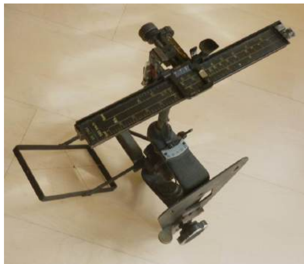
Izda. Puesto proel del ametrallador/bombardeo de otro Heinkel He.111 B1 armado, como el anterior, con una ametralladora MG.15 y un visor mecánico de bombardeo Goerz 6V.219d. Destaca, en el centro de la imagen el cronómetro que se necesitaba para el manejo de este último. Dcha. Visor mecánico de bombardeo Goerz Vizier 6V.219d de la Colección de Guerra Civil en Asturias del Museo Etnográfico e Histórico de Grado.
