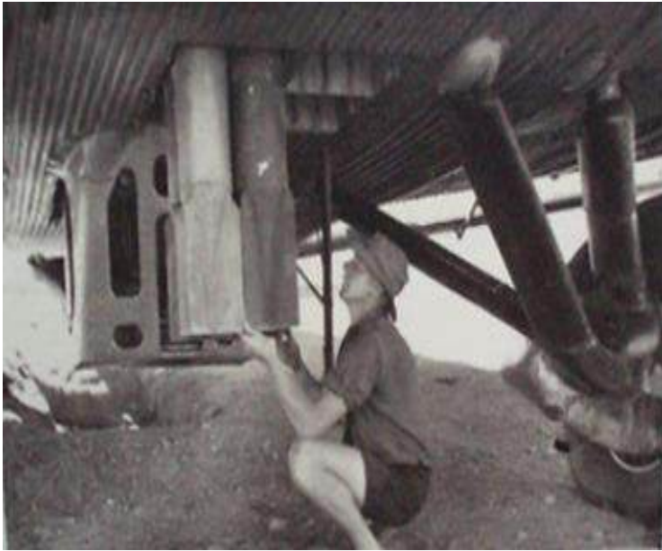
Cargando bombas en los pozos delanteros de los Ju.52. Izquierda, bombas SC50, de 50 kilos. Derecha, SC 250 de 250 kg.
