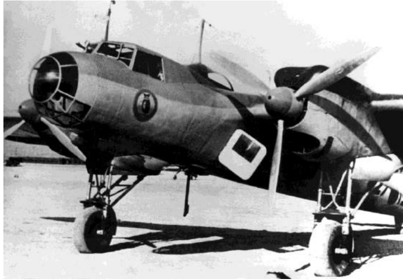
Tres Dornier Do.17 E-1 (De arriba abajo: 27-15 -“Buho en la rama”; 27-9 “Papa’s Liebling” y 27-25 “Barón de Münchhausen sobre una bomba SC”) nos muestran la parrilla del conjunto de puntería externa; en la de arriba, desdibujada por la ametralladora del parabrisas, a causa del encuadre.
