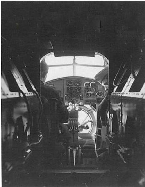
Izda.- Foto de un Heinkel He.111 B en la que se ve el puesto de ametralladora frontal, parte del cockpit y los lanzabombas ESAC/250/IX alineados de tres en tres –los terceros, apenas insinuados, se pierden por ambos laterales de la imagen-, enfrentados unos a otros. Dcha. Bomba SC.250 a medio cargar en el pozo izquierdo delantero.
