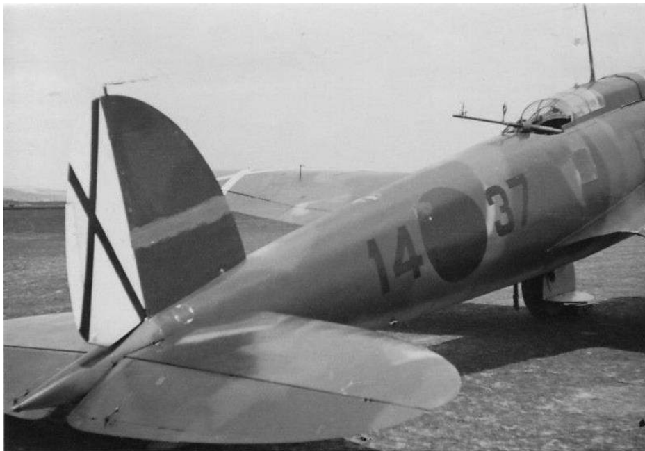
Vista desde cola de la única ametralladora que montaba el He-70, a disposición del observador y con sector de tiro solamente hacia atrás
