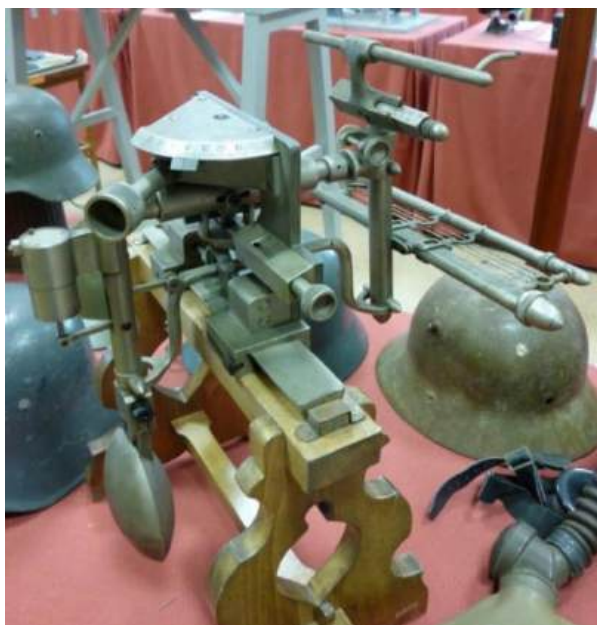
Visor de bombardeo mecánico italiano Mod. Jozza G.3. En España fue conocido como Jozza U.2. (Museo de la Academia Básica del Aire de La Virgen del Camino.)
