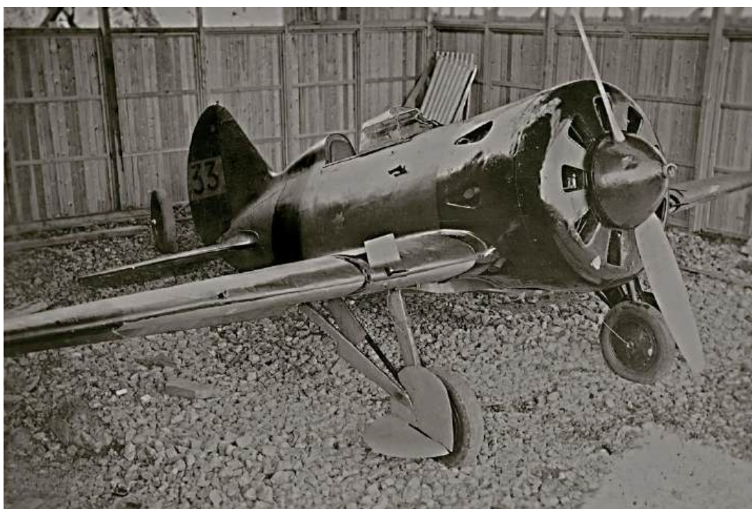
Polikarpov I.16 nº 33. El de mejor estado de entre los abandonados en Carreño. Tan bueno –casi en condiciones de vuelo.(El único daño que se aprecia es la rotura del extremo posterior del puro que dejó sin soporte al patín de cola, por lo que fue necesario utilizar para moverlo el carrito de dos ruedas que se ve tras él)- los miembros de la Cónдор se apresuraron a “requisarlo” y enviarlo a Alemania. (Foto Otto Schmidt, cedida por su hijo Heli Schmidt)
