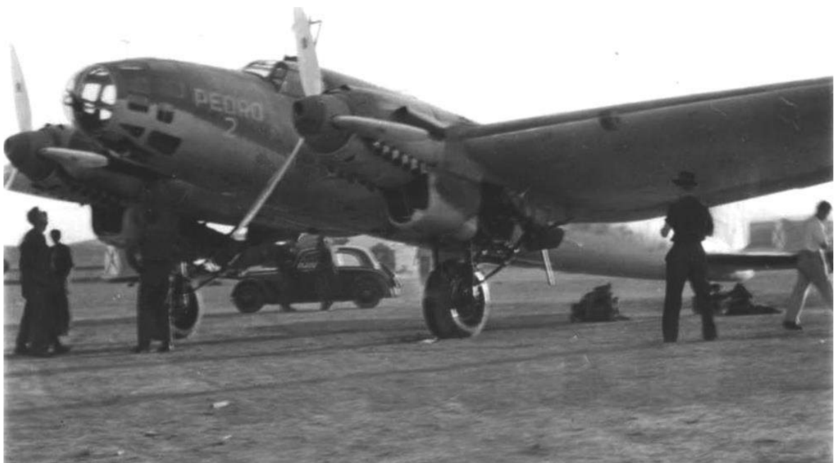
El “Pedro 2” 25-1, con idénticas características a las del 25-3 de la foto anterior propias de los bimotores de la preserie He.111 B-0.
