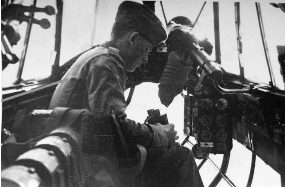
Puesto del ametrallador de proa con la MG.15 emplazada en el parabrisas derecho de un Dornier Do.17. Veanse en la esquina inferior izquierda la ubicación de los tambores de municiones para la alimentación de la máquina
