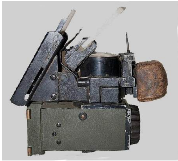
(Izda.). Cockpit de un Bf.109A mostrando el visor reflex Revi C/12B para la puntería de las ametralladoras (con el cristal apenas visible a causa de su transparencia). (Dcha) El más primitivo visor réflex Revi 3C que asimismo montaban algunos de los Bf.109A que operaron en España.
