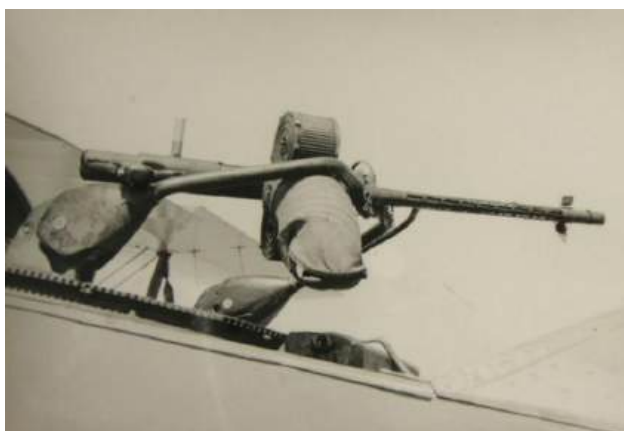
Puesto del observador/bombardero de un Heinkel He.45 y detalle de su ametralladora MG. 15; destaca la bolsa para la recogida de las vainas vacías de los cartuchos disparados
