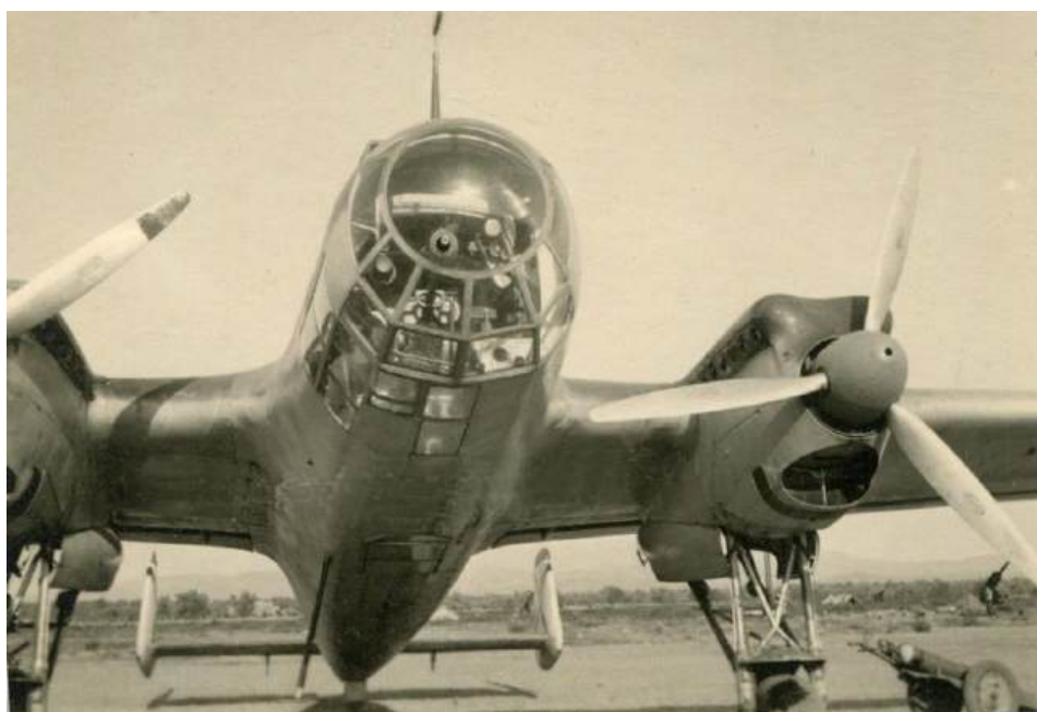
Vista externa del emplazamiento de la MG.15 de proa sobre montaje fijo en un Do.17 no identificado.
