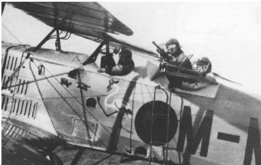
Mitrailleuse Portative Hotchkiss Mod. 1909 montada para su evaluación en el puesto del observador de un Breguet XIV durante la guerra de Marruecos.
