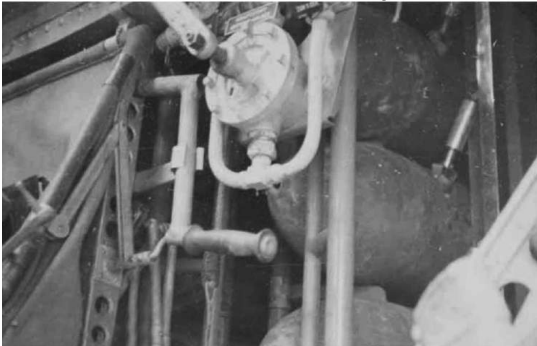
Lanzabombas horizontal Maga 5. C-50 y su corte esquemático frontal. El Do.17 E llevaba uno a cada lado de la bahía de bombas. Como bombardero no era una gran cosa.
