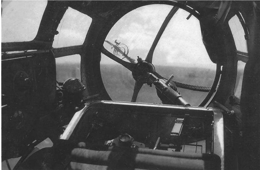
Heinkel He.111 B1 equipado con montaje de ametralladora GD-A 1114, de Ikaria Werke, y un visor de bombardeo Goerz Vizier 6V.219d.
