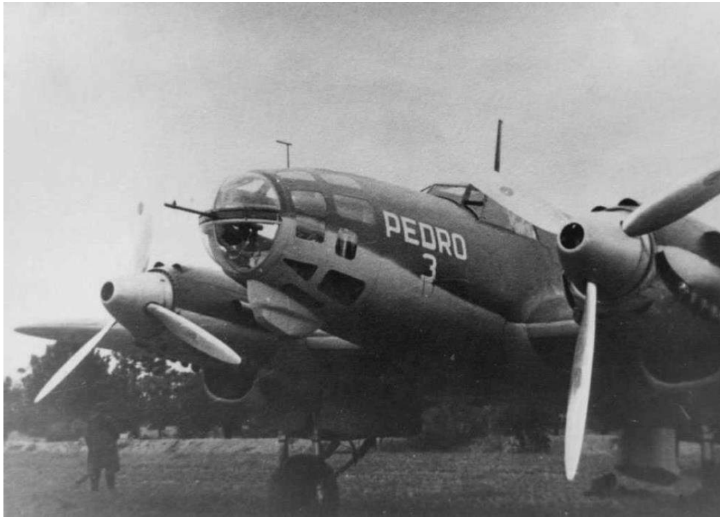
Imagen del Heinkel He.111 B-0 “Pedro 3” 25-2, mostrando en sus motores las cuatro tomas de aire suplementarias que precisaba el DB 600Aa.
