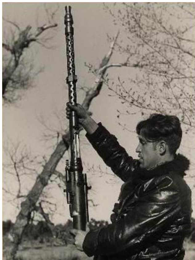
Ametralladora MG.17 de 7,92 mm (8x57 Mauser). Por aquel entonces la ametralladora estándar de los Bf.109 como arma de capot sincronizada con la hélice.
