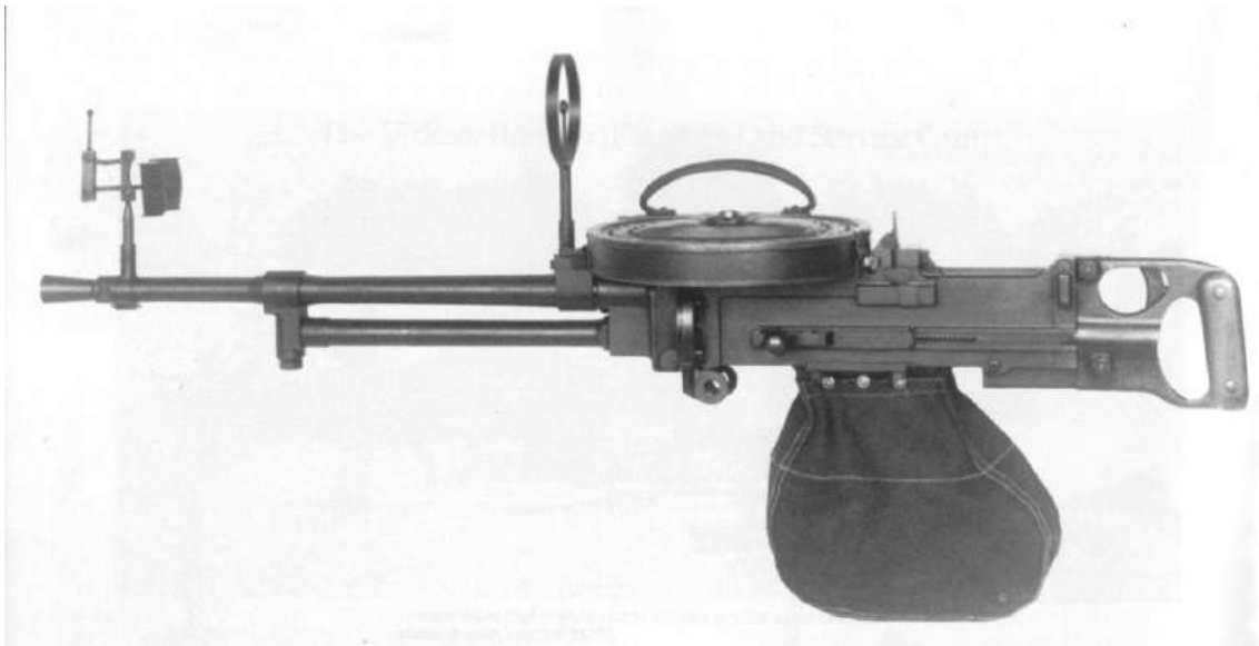
Ametralladora Vickers Clase K. Se aprecian sus elementos de puntería (punto de mira de veleta), cargador de disco y bolsa para la recogida de las vainas vacías.
