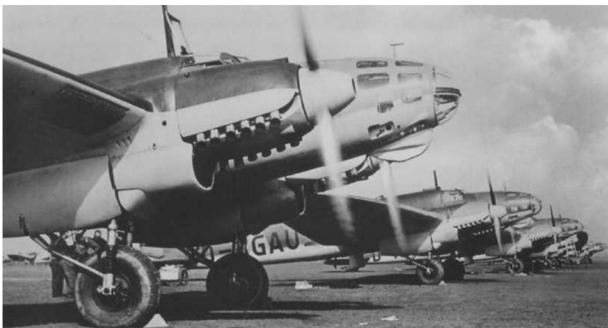
Los seis Heinkel He.111 de la preserie B-0, fotografiados en Alemania; con matrículas civiles. Con los montajes proeles de carril semicircular –aunque, en esta imagen, aún sin las ametralladoras- y las cuatro pequeñas tomas de aire suplementarias para los motores.
