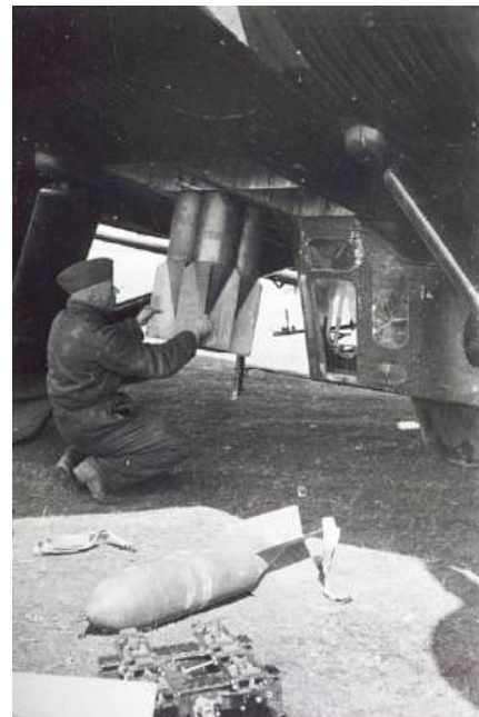
Cuatro bombas SC/50 dispuestas para ser izadas al pozo delantero de un Ju.52. Se hallan enganchadas al cuadrante que permite acoplarlas y manejarlas desde un lanzabombas diseñado para una sola de 250 kg. En ambas fotos se aprecia en el suelo, suelto, uno de tales cuadrantes.
