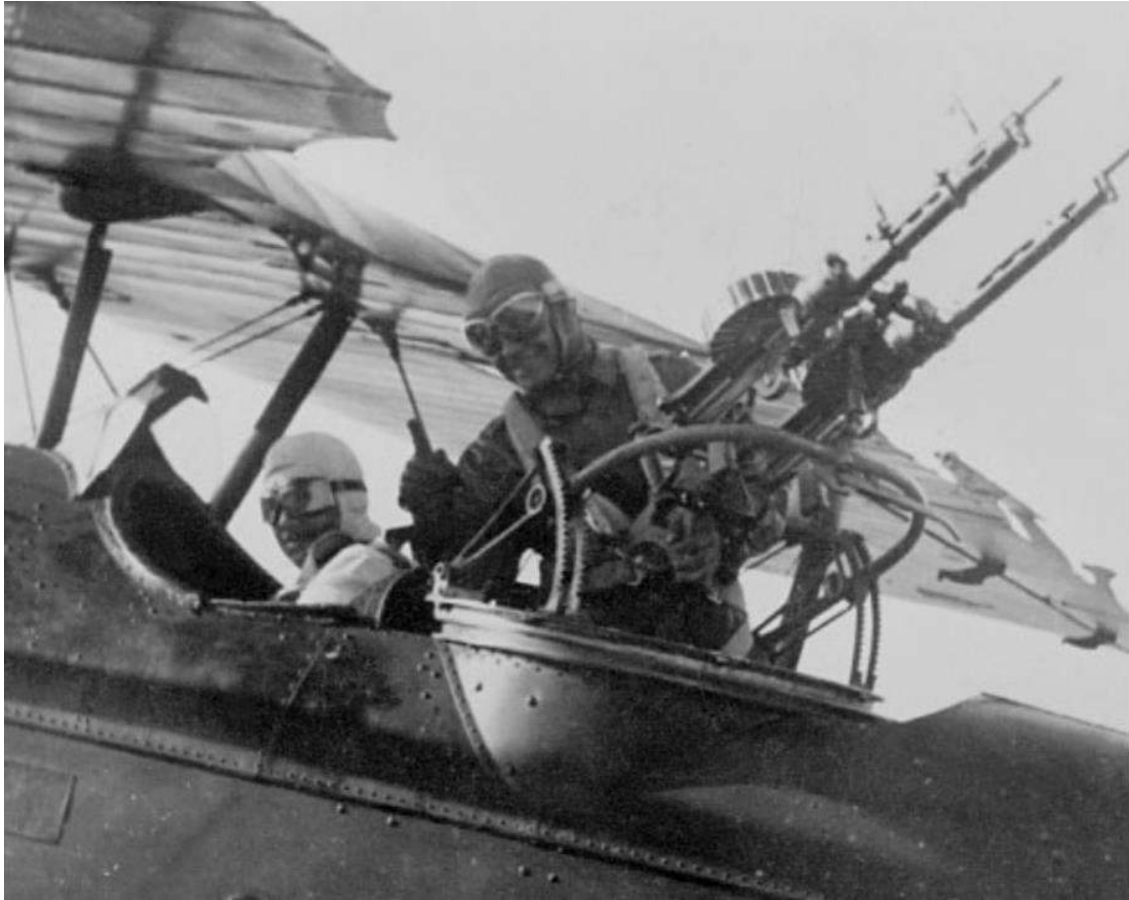
Puesto del observador bombardero de un Potez 25 armado con dos ametralladoras Lewis de 7,7 mm (.303 British) sobre anillo Scarff.
