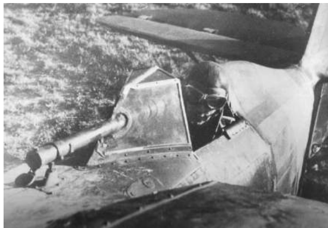
Visor de puntería tipo Galileo OP-1 (licencia Goerz) que montaban los I.15.
