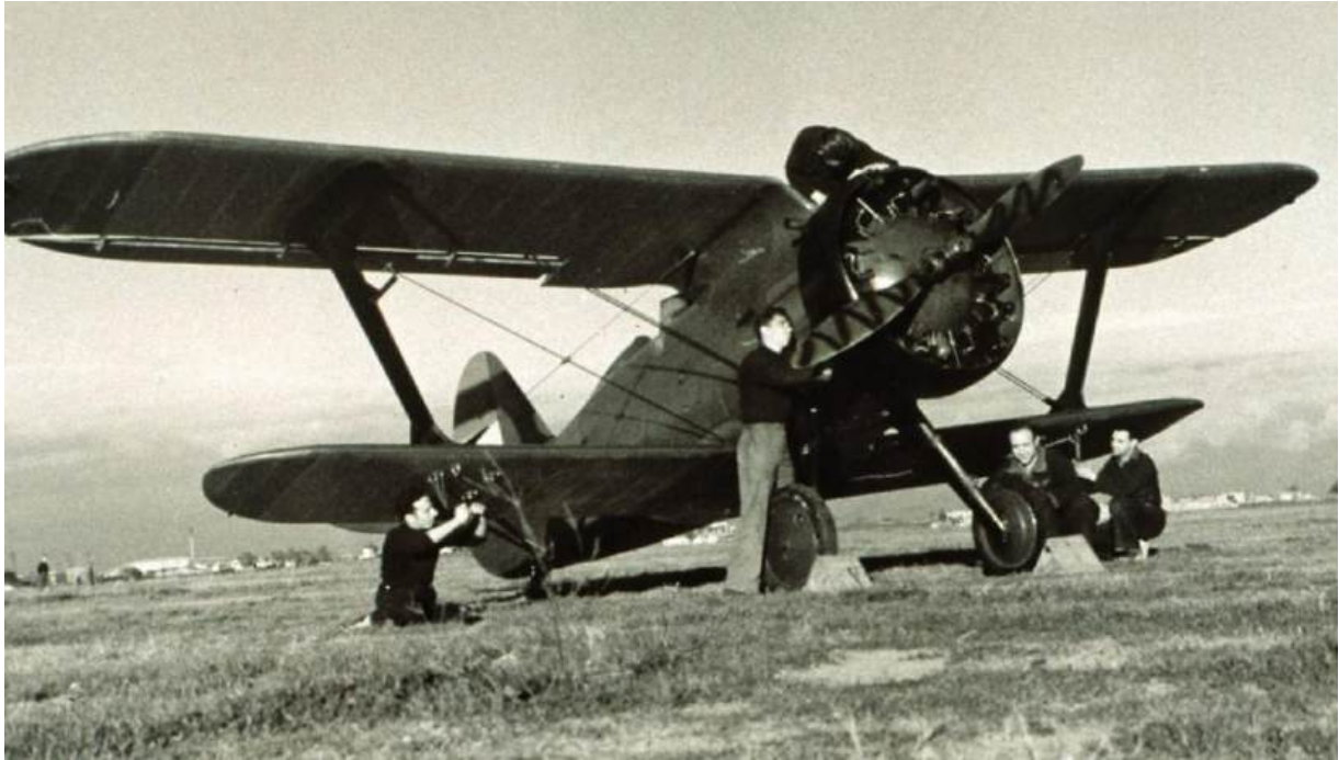
Montaje de los lanzabombas subalares en un I-15 "Chato".
