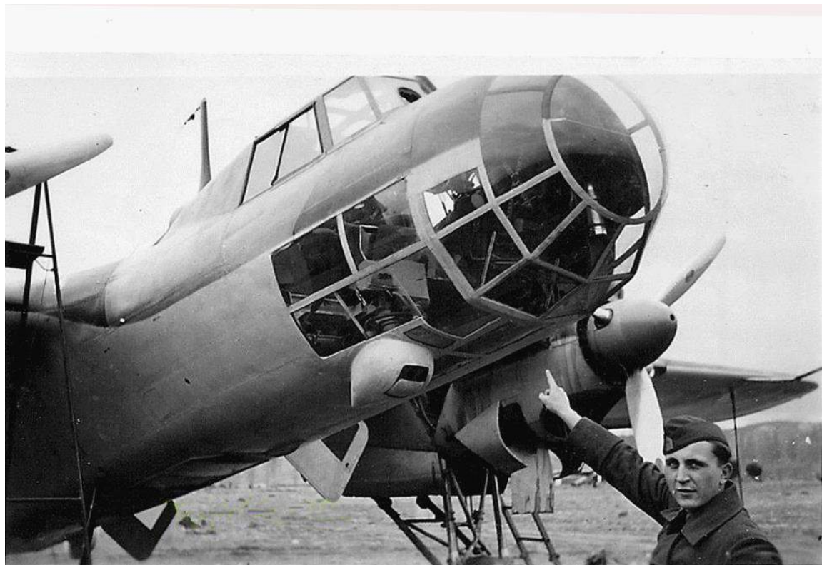
Fotografías de dos Dornier Do.17 de la Legión Cóndor equipados con visores electro-ópticos. Al estar tomadas desde el exterior no permiten apreciar los detalles necesarios para precisar su modelo. Adviértase que al aparato de la foto superior –un Do.17P– no se le ha instalado aún el bulbo protector.
