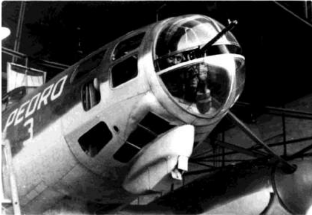
Izda.- Montaje semicircular de los He.111B-0. Dcha.- Montaje cruciforme Ikaria de los He.111 B-1 y siguientes.
