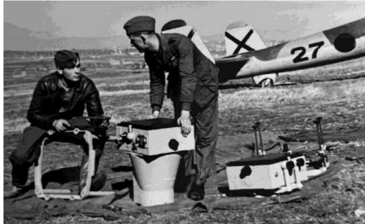
Dos suboficiales especialistas preparando las cámaras fotográficas para instalarlas en un Do.17 F-1.
