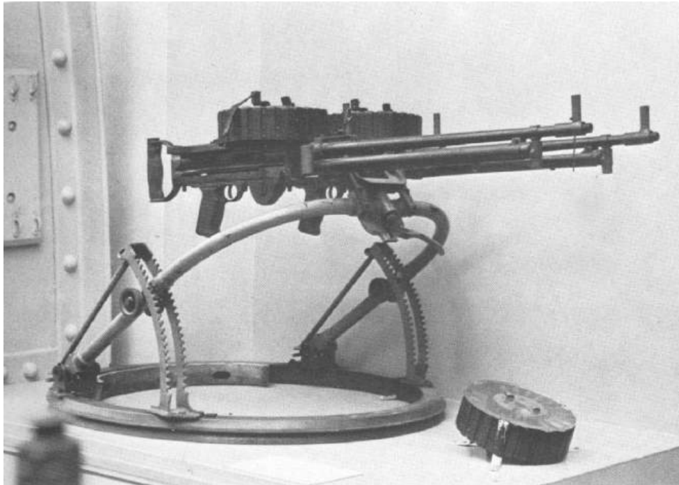
Torreta Scarff con montaje doble de ametralladoras Lewis. Aunque en 1934 los Breguet iban armados mayoritariamente con ametralladoras Darne, solían en alguna ocasión utilizar las más antiguas Lewis
