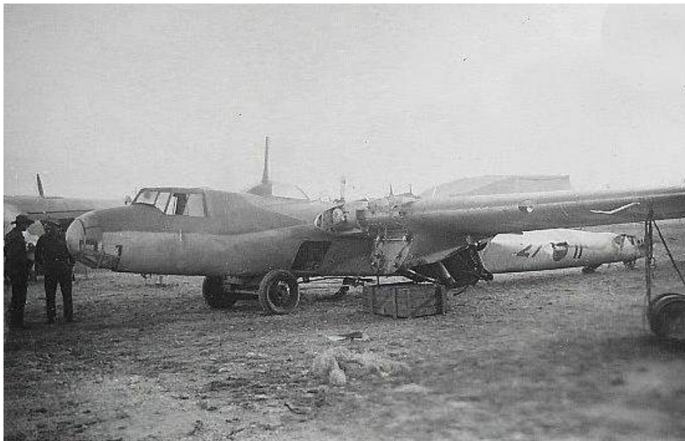
Aspecto del Dornier 27-11, tras su accidente del 15 de agosto, listo para el traslado a talleres. Le han sido retirados los motores, las dobles derivas y el tren de aterrizaje.
