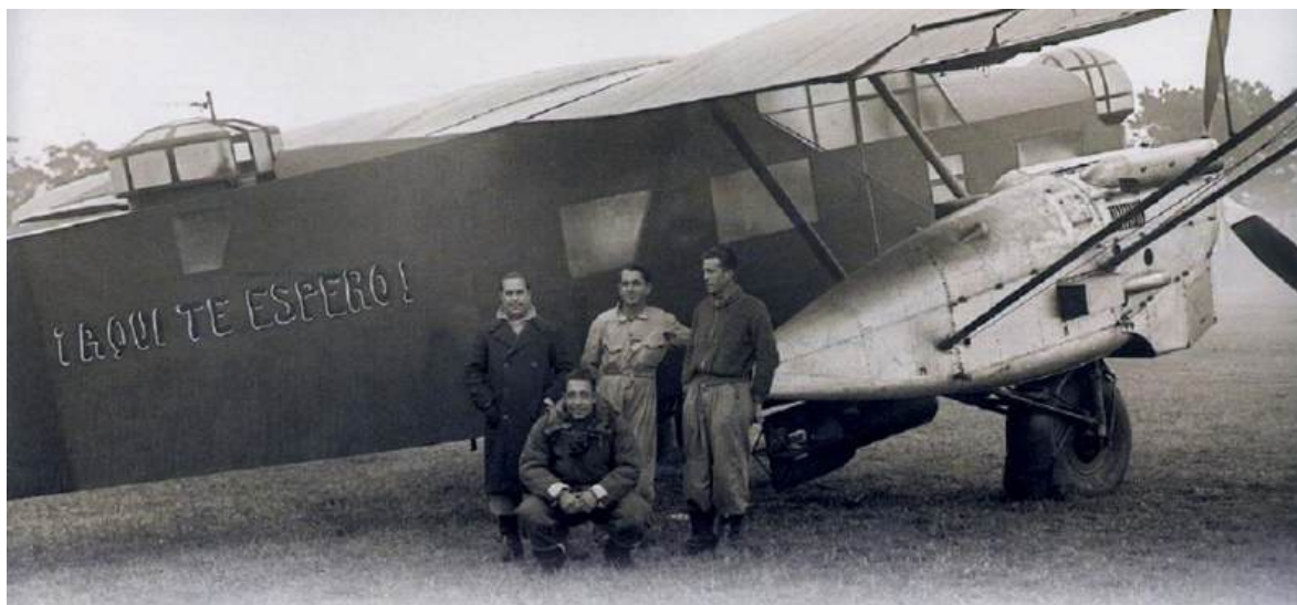
La leyenda ¡AQUÍ TE ESPERO! que el Potez 540 matrícula F, llevaba en el costado. Adviértase que la ametralladora de la torre es una Vickers G.O.
