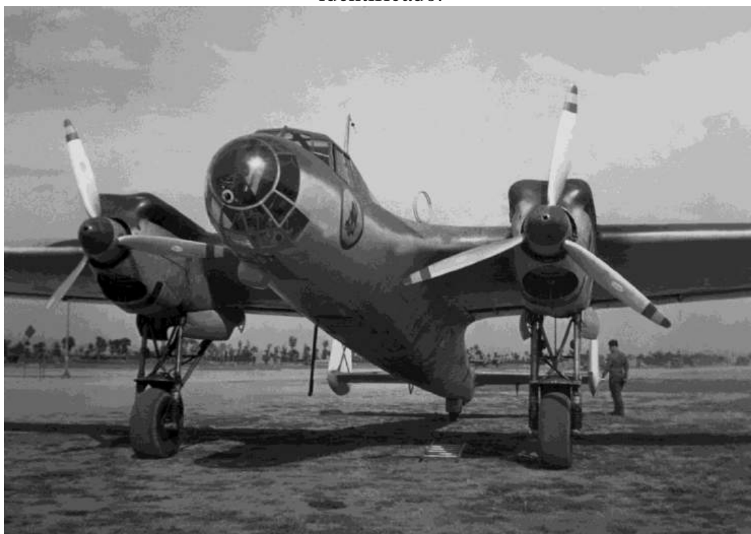
Vista externa del emplazamiento de la MG.15 de proa sobre montaje fijo en un Do.17 no identificado.
