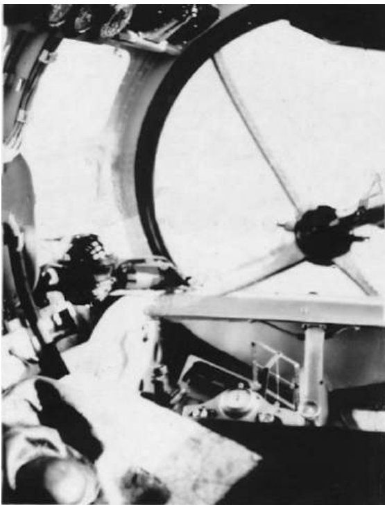
Izda. Puesto proel del ametrallador/bombardeo de otro Heinkel He.111 B1 armado, como el anterior, con una ametralladora MG.15 y un visor mecánico de bombardeo Goerz 6V.219d. Destaca, en el centro de la imagen el cronómetro que se necesitaba para el manejo de este último. Dcha. Visor mecánico de bombardeo Goerz Vizier 6V.219d de la Colección de Guerra Civil en Asturias del Museo Etnográfico e Histórico de Grado.
