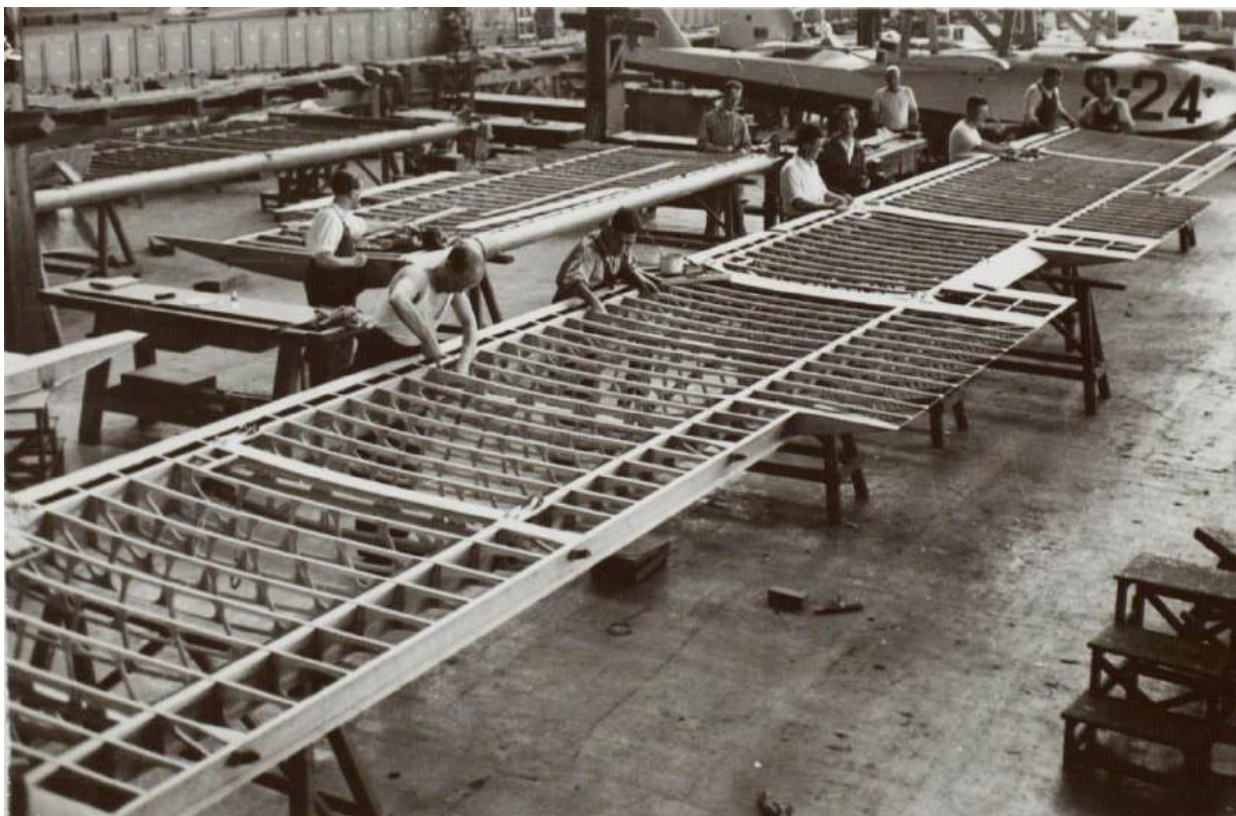
El 18 de julio de 1936, al producirse el alzamiento militar, los talleres del Contradique de Barcelona aún estaban trabajando en la construcción de los Savoia S.62 de la última serie encargada por la Aeronáutica Militar.(Foto Biblioteca Naci
