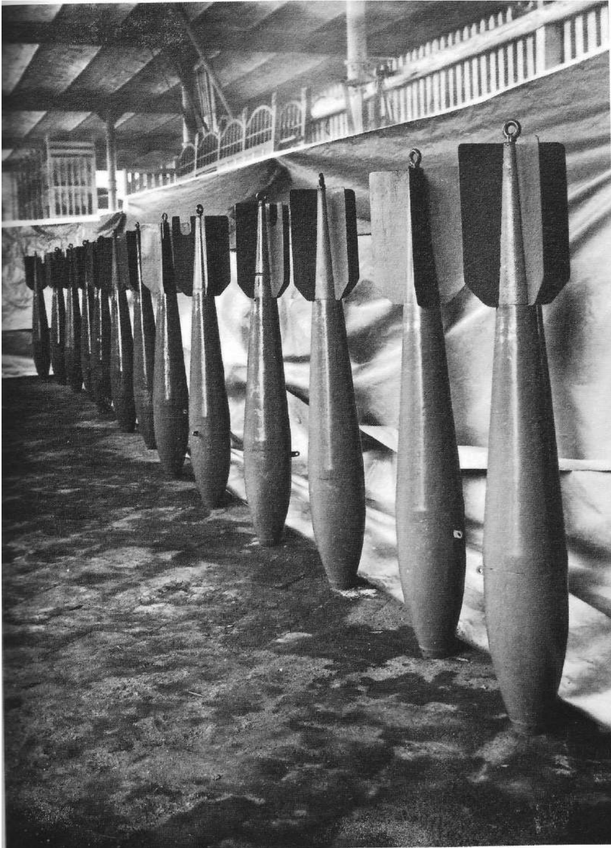
Bombas Hispania Mod. A.6, de 50 kg, recién fabricadas; aún sin la carga explosiva ni, por supuesto, la espoleta. En las operaciones sobre Asturias constituyeron la carga exclusiva de los Aero Ab.101 de las que llevaban ocho por aparato.
