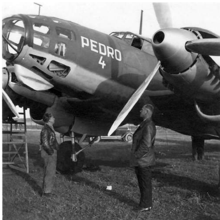
En cambio, el “Pedro 4” 25-4, como todos los que le siguieron, presentaba la carcasa del Motor DB 600C lisa -sin las tomas suplementarias- y el montaje cruciforme Ikaria de la ametralladora frontal normalizada para los He.111 de la serie B-1 y siguientes.
