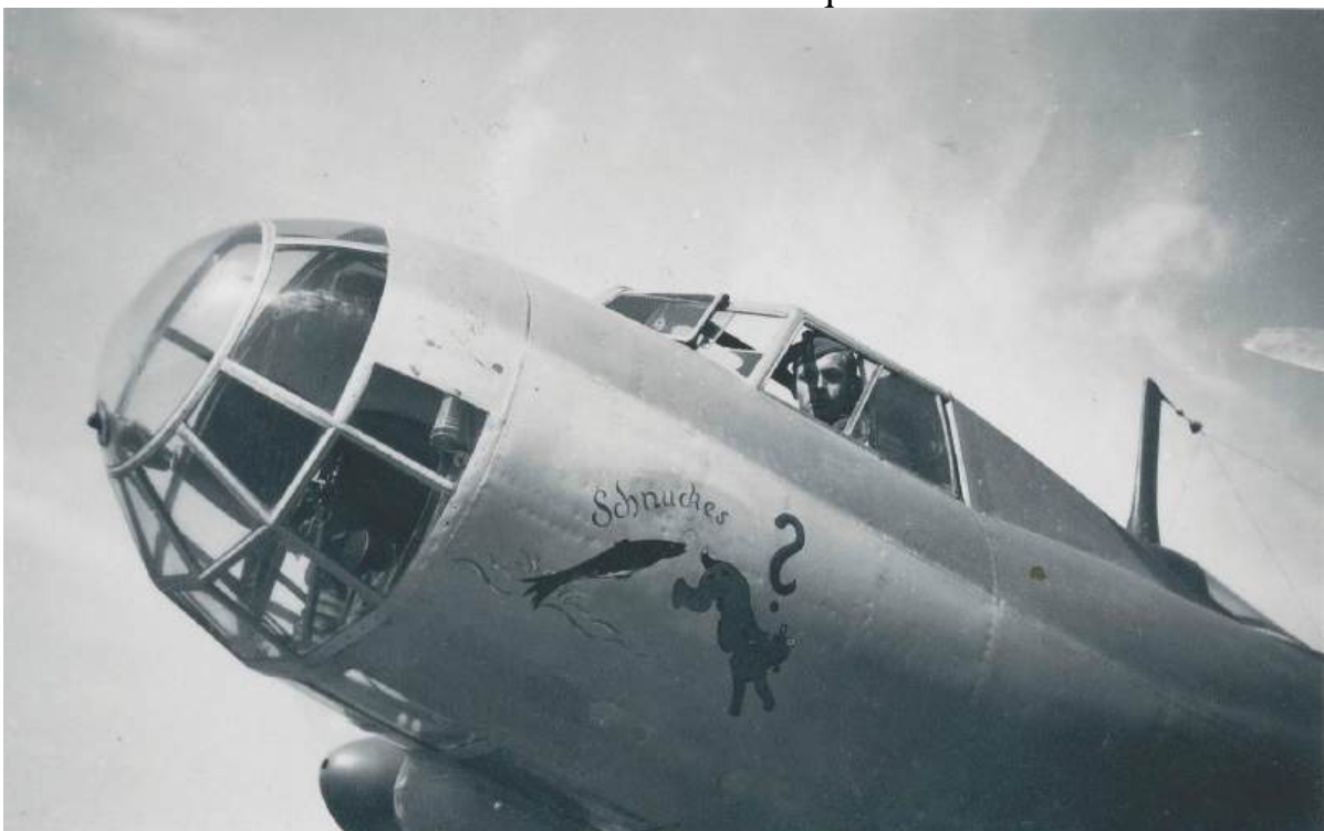
Puesto del ametrallador de proa con la MG.15 emplazada en el parabrisas derecho de un Dornier Do.17. Veanse en la esquina inferior izquierda la ubicación de los tambores de municiones para la alimentación de la máquina
