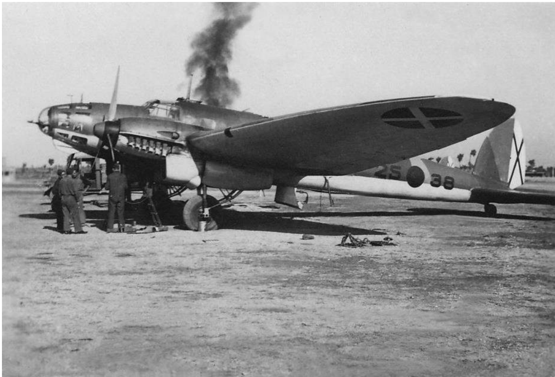
Heinkel He.111 B-2 25-38. Adviértase la toma de aire para el carburador de tamaño muy reducido y los tubos de escape más largos. El hecho de que empezaran a recibirse aparatos de la variante B-2 no quiere decir que cesaran los envíos del B-1 pues, como se ha dicho, Alemania enviaba lo que iba teniendo disponible y en España se matriculaban según el orden de recepción independientemente de la variante que fueran.
