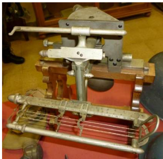
Visor de bombardeo mecánico italiano Mod. Jozza G.3. En España fue conocido como Jozza U.2. (Museo de la Academia Básica del Aire de La Virgen del Camino.)
