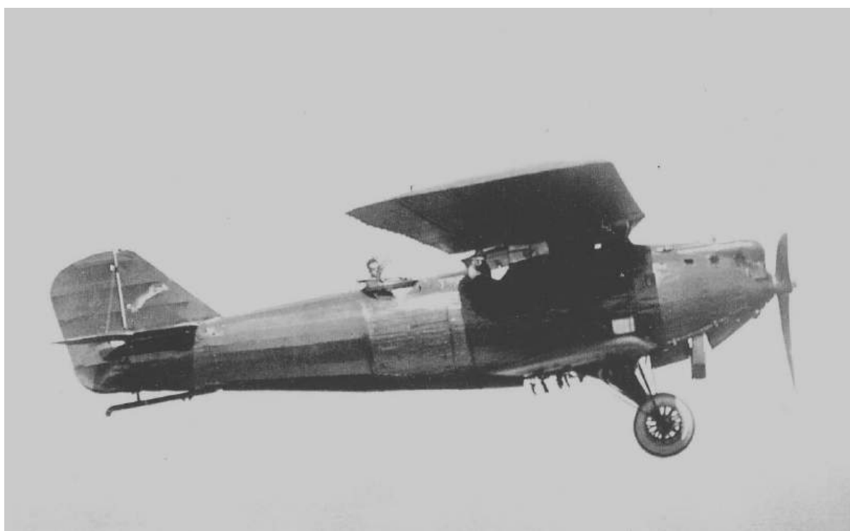
Breguet XIX de construcción francesa con motor Lorraine 12 Db de 400 cv.
