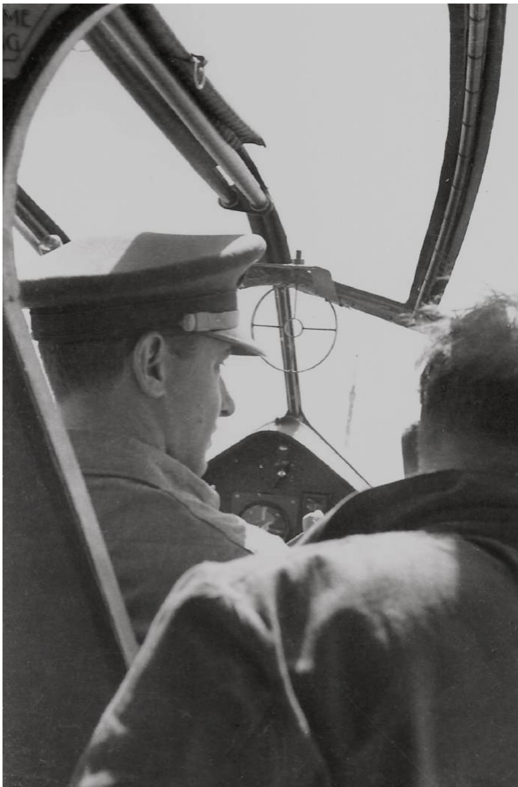
Cabina del DH.89M. Se aprecia la parrilla anular de puntería y se vislumbra el punto de mira con que contaba el piloto para dirigir el fuego de la ametralladora Vickers Clase "E" de que disponía.
