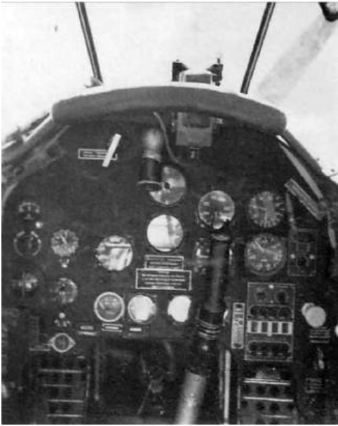
(Izda.). Cockpit de un Bf.109A mostrando el visor reflex Revi C/12B para la puntería de las ametralladoras (con el cristal apenas visible a causa de su transparencia). (Dcha) El más primitivo visor réflex Revi 3C que asimismo montaban algunos de los Bf.109A que operaron en España.
