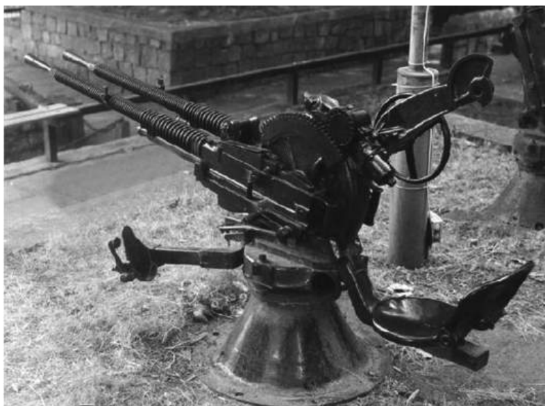
Montaje a/a. doble Hotchkiss de 13,2 mm. del tipo artillado en el "Císcar".
