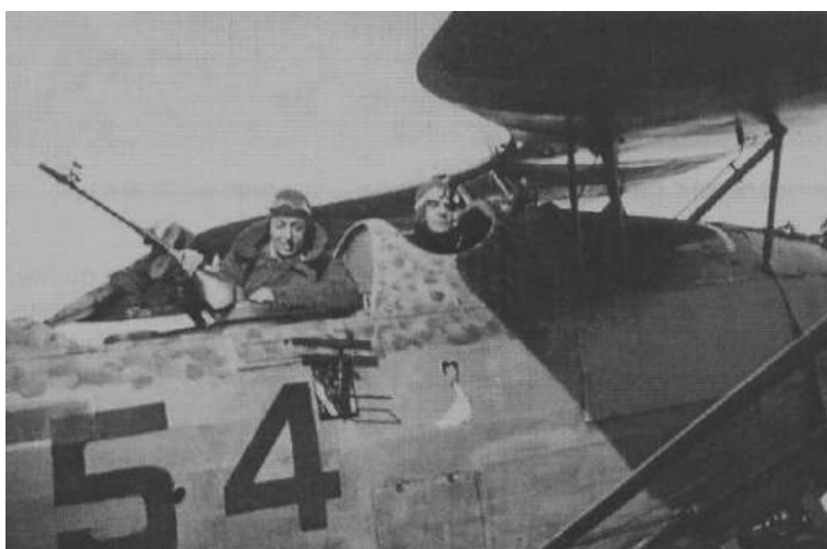
Dos vistas del mismo Heinkel He.46, matrícula 11-154, en las que se aprecia la mira de bombardeo Goerz Visier 6V.219d junto a una muñequita pintada como mascota. En la foto inferior, se ve mejor la ametralladora MG.15, única que montaba el aparato.
