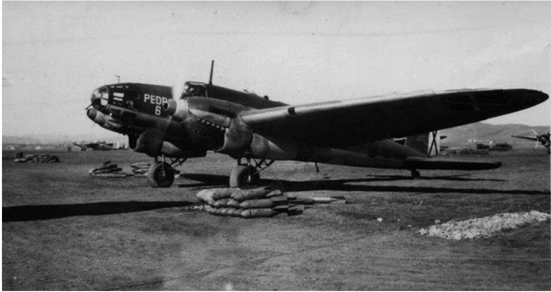
El “Pedro 6”, con las carcasas de sus motores lisas, los tubos de escape cortos, el montaje Ikaria de la ametralladora proel y la tapa larga de la toma de aire del carburador: un ejemplar representativo de la variante He.111 B-1
