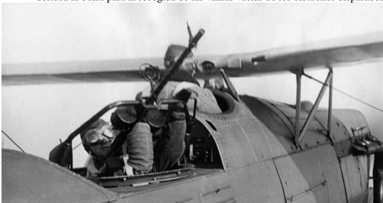
El metrallador de un Heinkel He.45 nos muestra las posibilidades de puntería que le brinda el montaje de su máquina.
