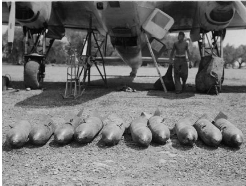
Exhibición ante un Do.17 E-1 de la menguada carga de bombas que utilizaba habitualmente: diez SC/50 de 50 kilos.
