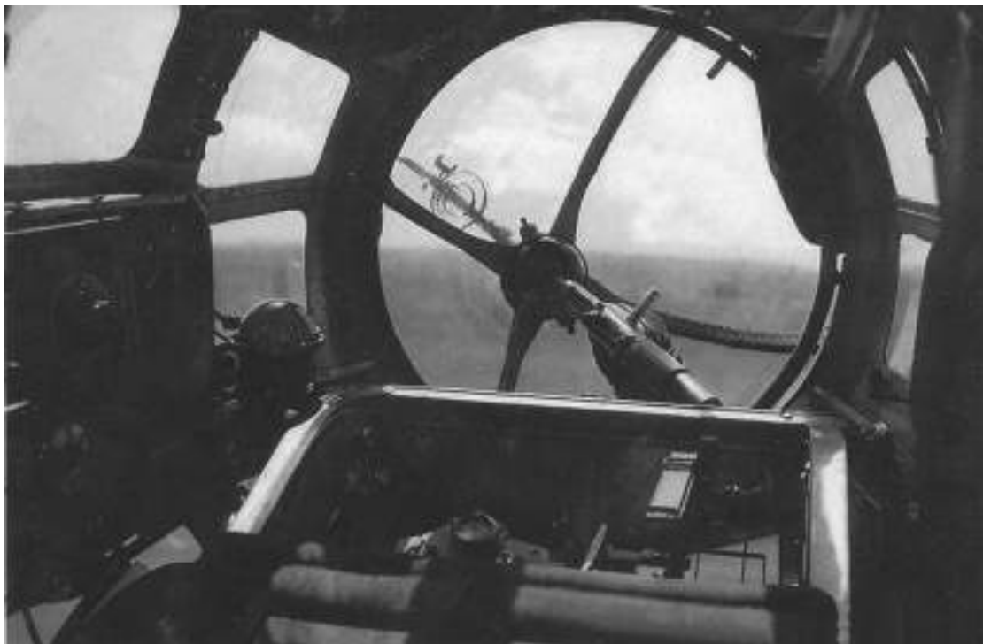
Heinkel He.111 B1 equipado con montaje de ametralladora GD-A 114, de Ikaria Werke y un visor de bombardeo Goerz Vizier 6V.219d.
