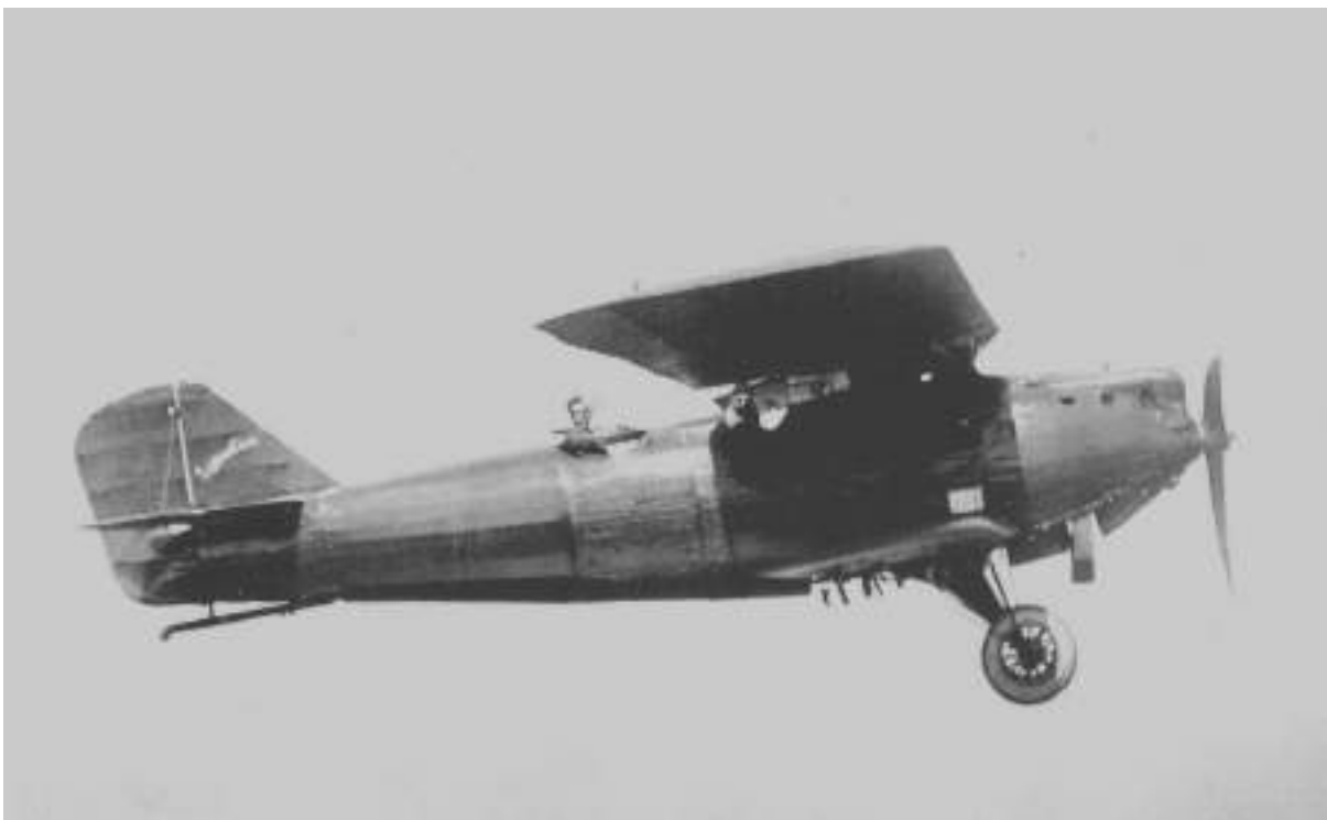
Breguet XIX de construcci n francesa con motor Lorraine 12 Db de 400 cv.
