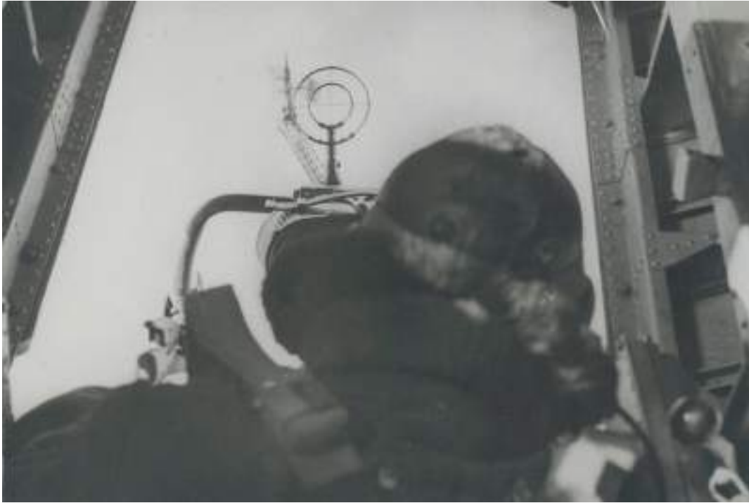
Puesto y ametralladora ventrales, fotografiados desde el interior de un Heinkel He.111
