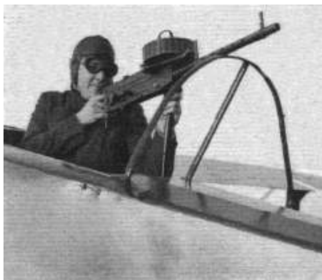
Puesto defensivo dorsal del “Dragon” con su ametralladora Vickers Clase “F” que, por cierto, no tiene colocados los elementos de puntería.
