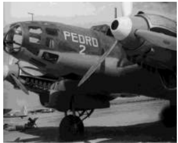
El 25-3 “Pedro 1” y el 25-1 “Pedro 2” mostrando los montajes semicirculares de la ametralladora de proa originales, con los que llegaron a España.
