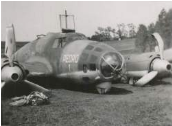
El 25-3 “Pedro 1” y el 25-1 “Pedro 2” mostrando los montajes semicirculares de la ametralladora de proa originales, con los que llegaron a España.
