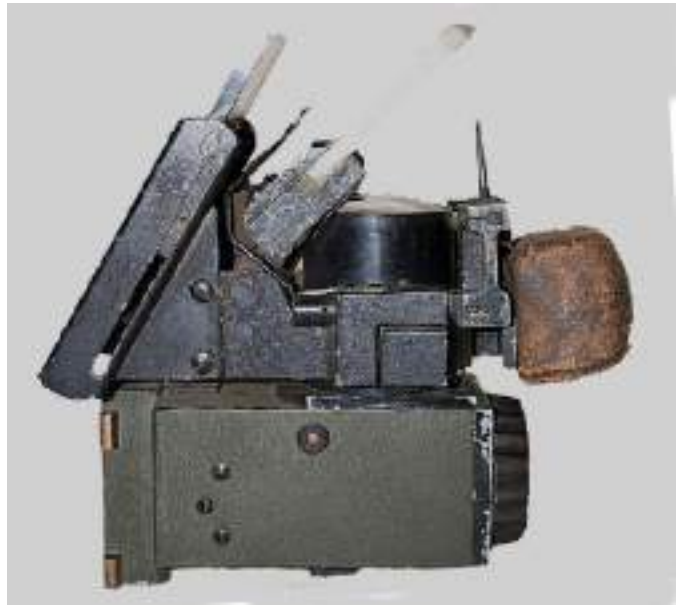
(Izda.). Cockpit de un Bf.109 mostrando el visor reflex Revi C/12B para la puntería de las ametralladoras (con el cristal apenas visible a causa de la transparencia). (Dcha) El más primitivo visor réflex Revi 3C que asimismo montaban algunos de los Bf.109A que operaron en España.
