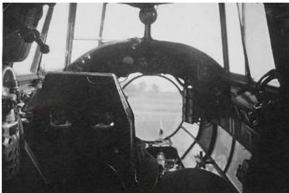
Ametralladora de proa de un Do.17 E-1 en afuste semirígido. A la derecha de ella, algo retrasado, se ve el visor de bombardeo Goerz Vizer 6V.219d que montaban los primeros bombarderos Do.17 E-1 llegados a España.
