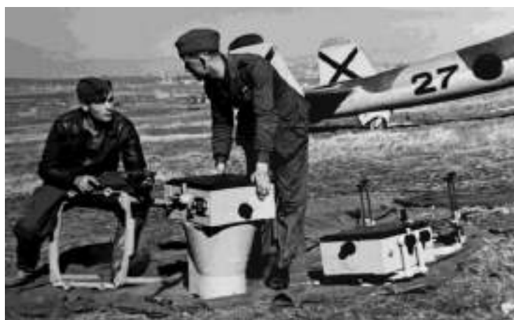
Dos suboficiales especialistas preparando las cámaras fotográficas para instalarlas en un Do.17 F-1.
