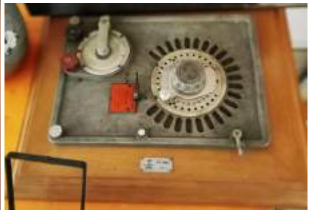
Secuenciador eléctrico de bombardeo RA (Reihen-Abwurf-Automat). Adviértase que ve graduado para 24 bombas (de 50 kg.); o sea, para seis pozos de bombardeo (Colección del Museo de El Cuetu.
