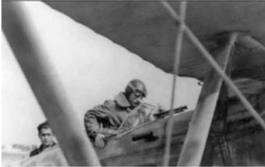
Visor tubular Chrétien, de la firma San Giorgio montado en el Fiat Cr.32
