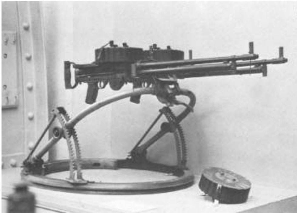
Torreta Scarff con montaje doble de ametralladoras Lewis. Aunque en 1934 los Breguet iban armados mayoritariamente con ametralladoras Darne, es fácil que en alguna ocasión utilizaran las más antiguas Lewis
