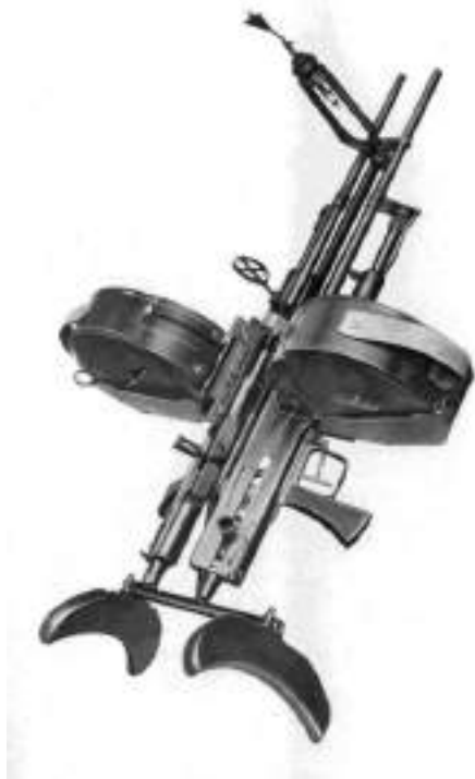
Montaje doble de ametralladoras Darne. Su aspecto sobre la torreta Scarff y provisto de los dos tambores de munición resultaba, cuando menos, espectacular.
