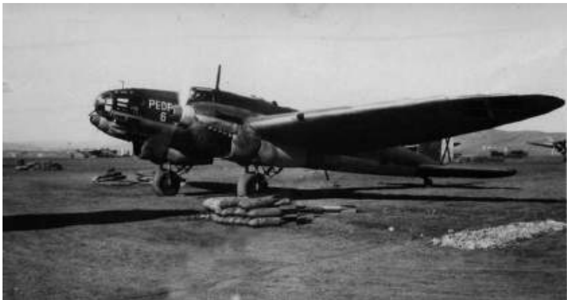
El “Pedro 6”, con las carcasas de sus motores lisas, los tubos de escape cortos y el montaje Ikaria de la ametralladora proel es un ejemplar representativo de la variante He.111 B-1
