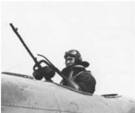
Puesto defensivo dorsal armado con una ametralladora MG.15 de 7,92 mm. En la foto de la derecha se ve claramente –a la izquierda– el pequeño parabrisas que protegía al ametrallador.
