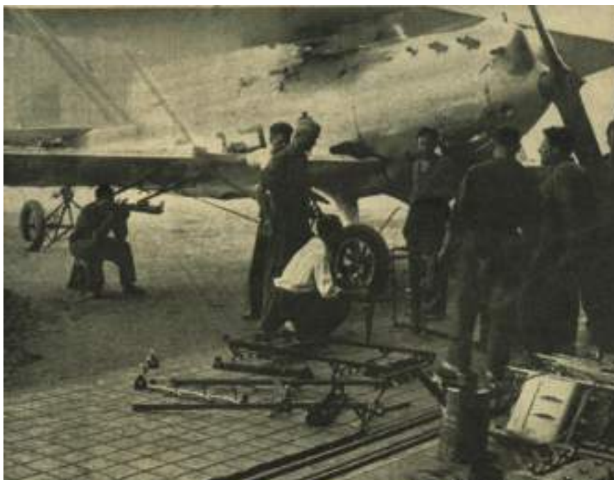
Montaje de lanzabombas externos horizontales en un Breguet XIX. Ya está instalado bajo el plano izquierdo un 2-A-6, mientras que en el suelo vemos otro de este mismo tipo –destinado probablemente al plano derecho– y un 6-A-5. En realidad, este último eran dos 3-A-5 acoplados en tándem.
