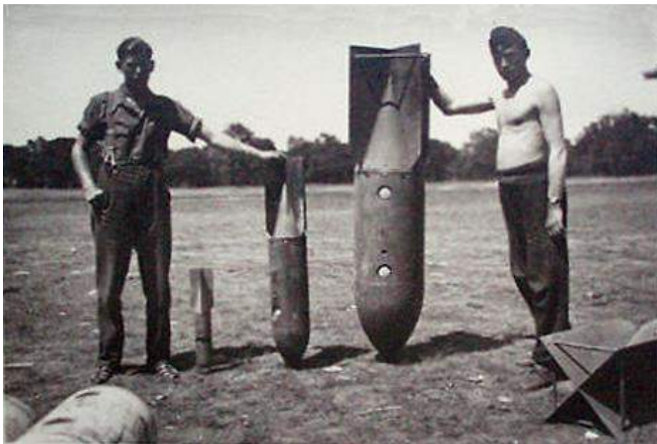
Los tres tamaños de bombas explosivas que podían llevar los lanzabombas DSAC 250-VIII: de 10, 50 y 250 kg. Para colocar las bombas SC-10 o SC-50 en el lanzabombas era necesario usar unos suplementos que las ajustaran al interior del mismo. Los círculos que se ven en los cuerpos de las bombas SC-50 y SC-250 son los alojamientos para las espoletas eléctricas “El. AZ C.50”
