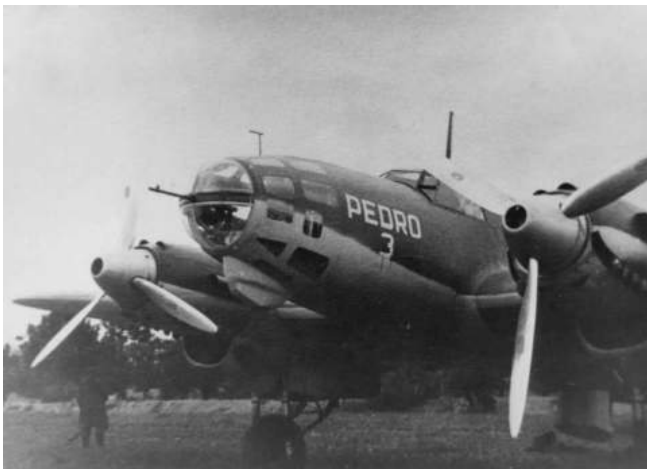
Imagen del Heinkel He.111 B-0 “Pedro 3” 25-2, mostrando en sus motores las cuatro tomas de aire suplementarias que precisaba el DB 600Aa.
