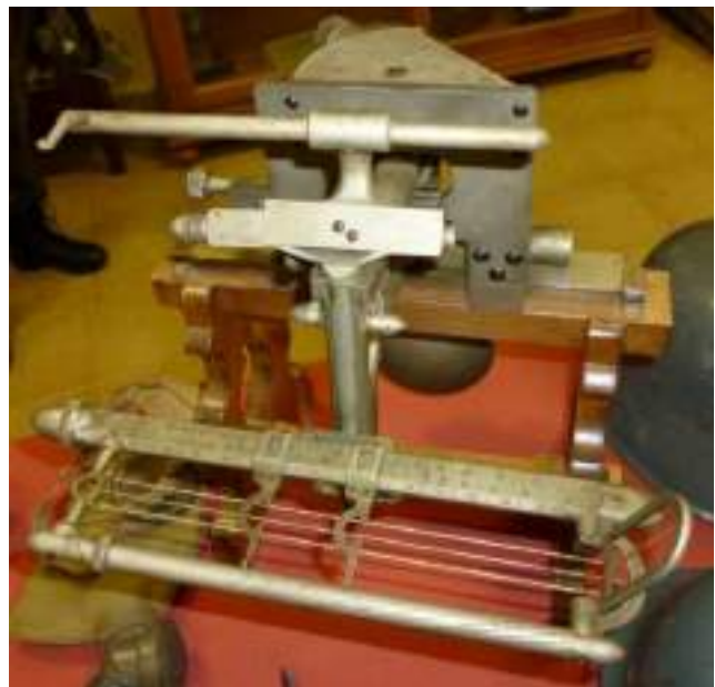
Visor de bombardeo mecánico italiano Mod. Jozza G.3. En España fue conocido como Jozza U.2. (Museo de la Academia Básica del Aire de La Virgen del Camino.)
