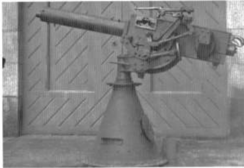
Ametralladora Maxim de 37 mm. transformada en antiaéreo de circunstancias en el Arsenal de Ferrol, para su propia defensa contra los bombardeos aéreos.
