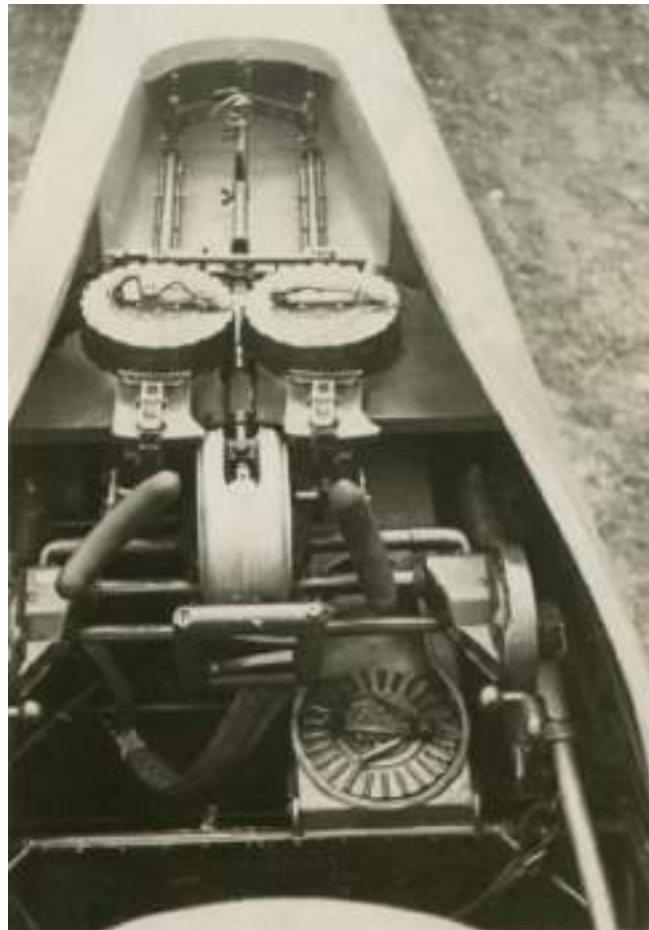
Montaje de metraladoras Lewis en el puesto del observador/bombardero. La imagen nos lo muestra en posición replegada, en la que no sobresalía del dorso del fuselaje
