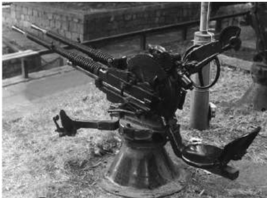
Montaje a/a. doble Hotchkiss de 13,2 mm. del tipo del artillado en el “Císcar”.
