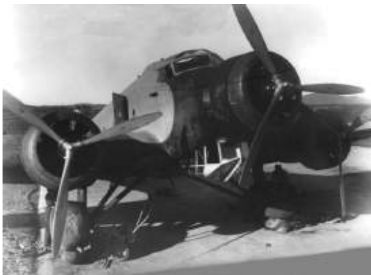
Savoia S.81 mostrando la cabina semieclipsable del bombardero debajo y detrás del motor Cental
