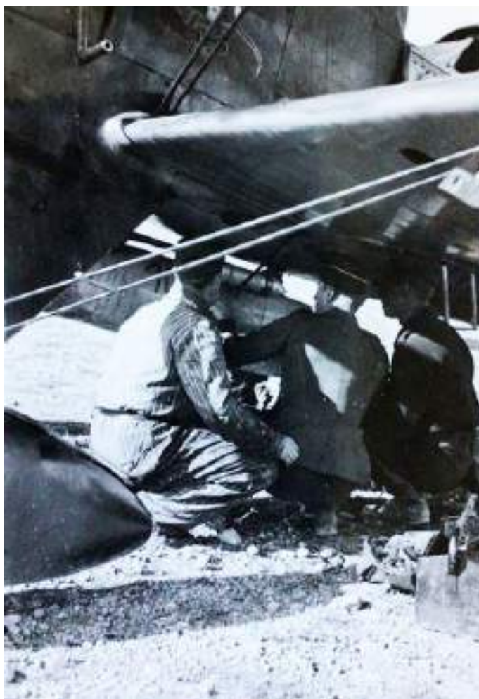
Armeros de la Legión Cóndor atan una bomba SC.10 al depósito de gasolina supletorio de un Heinkel He-51, para transformarlo en una “primitiva bomba de napalm”.
