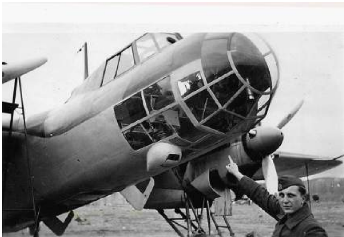
Fotografías de dos Dornier Do.17 de la Legión Cóndor equipados con visores electro- ópticos. Al estar tomadas desde el exterior no permiten apreciar los detalles necesarios para precisar su modelo. Adviértase que al aparato de la foto superior no se le ha instalado aún el bulbo protector.
