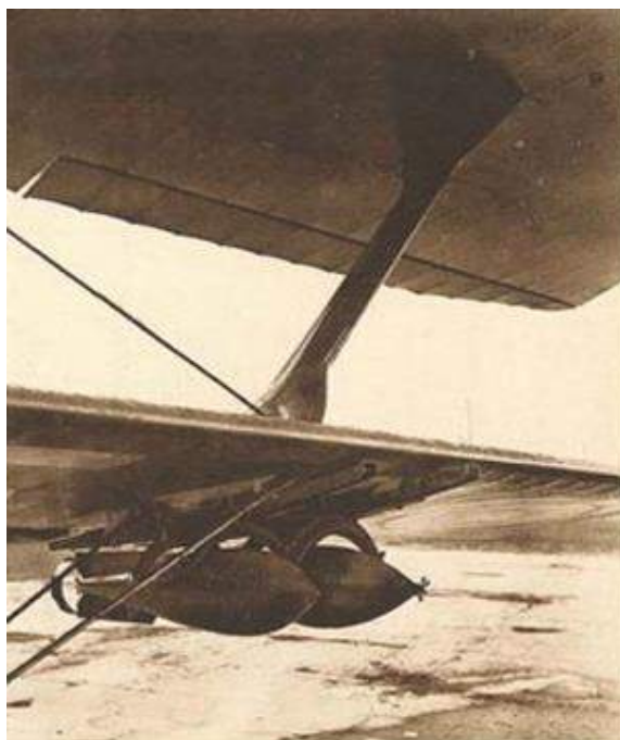
Lanzabombas externos, bajo los planos, para bombas de 100 kg.
