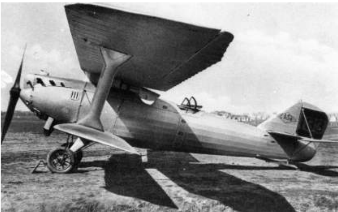
CASA/Breguet XIX con motor Hispano Suiza de 500 cv. Se trata del número de fabricación 133, último de la segunda serie española
