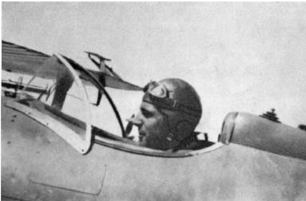
Visor tubular Chrétien, de la firma San Giorgio montado en el Fiat Cr.32
