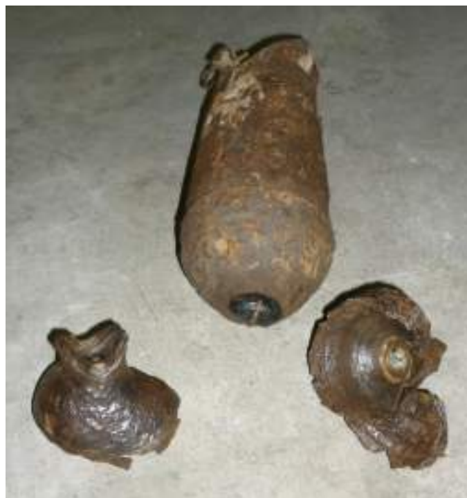
Restos de bombas rusas AO-10 encontrados en Asturias; concretamente, en los alrededores de Grado y Pola de Siero. (Museo Militar de El Cuetu y Museo Etnográfico y de Historia de Grado)
