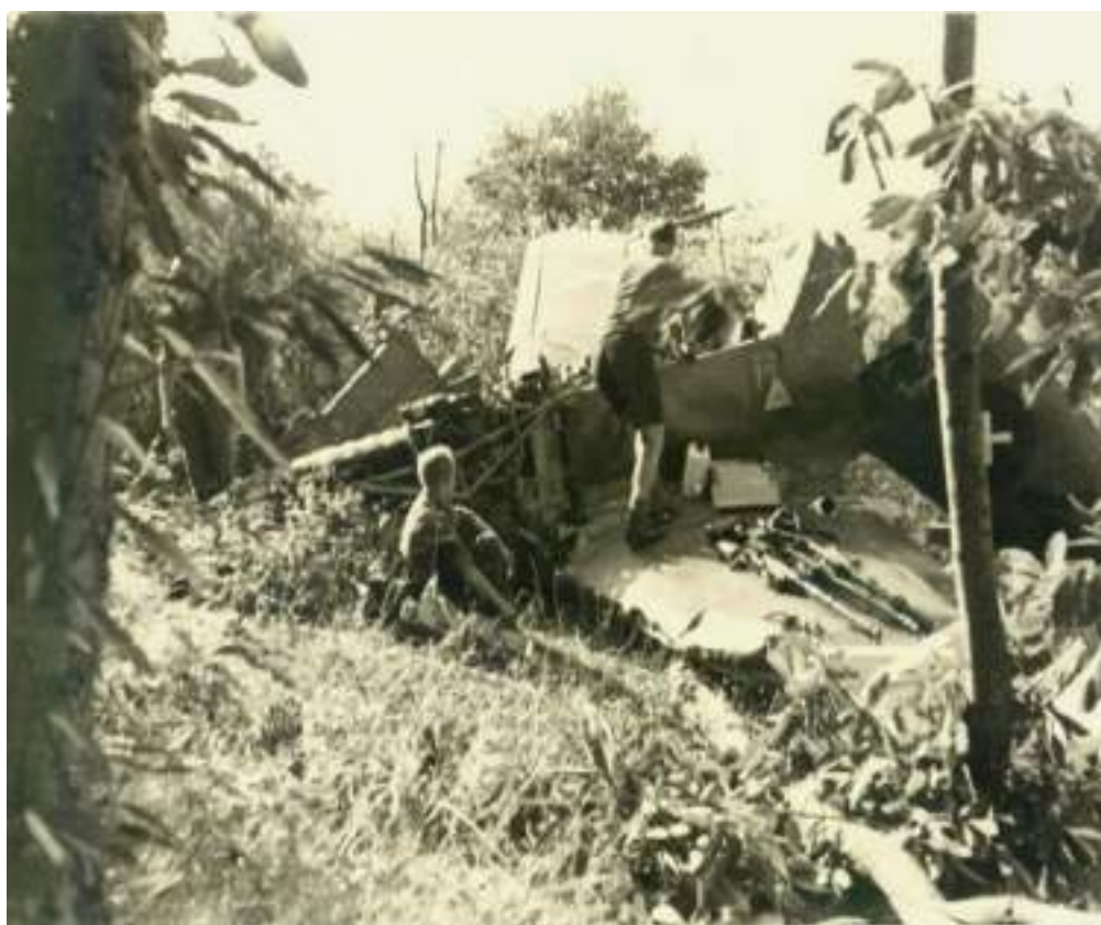
Ya han comenzado los trabajos para recobrarlo y le han sido extraídas las tres ametralladoras, detalle éste que permite identificar al avión como un BF.109B1, equipado con una tercera MG.17 que disparaba a través del buje de la hélice.
