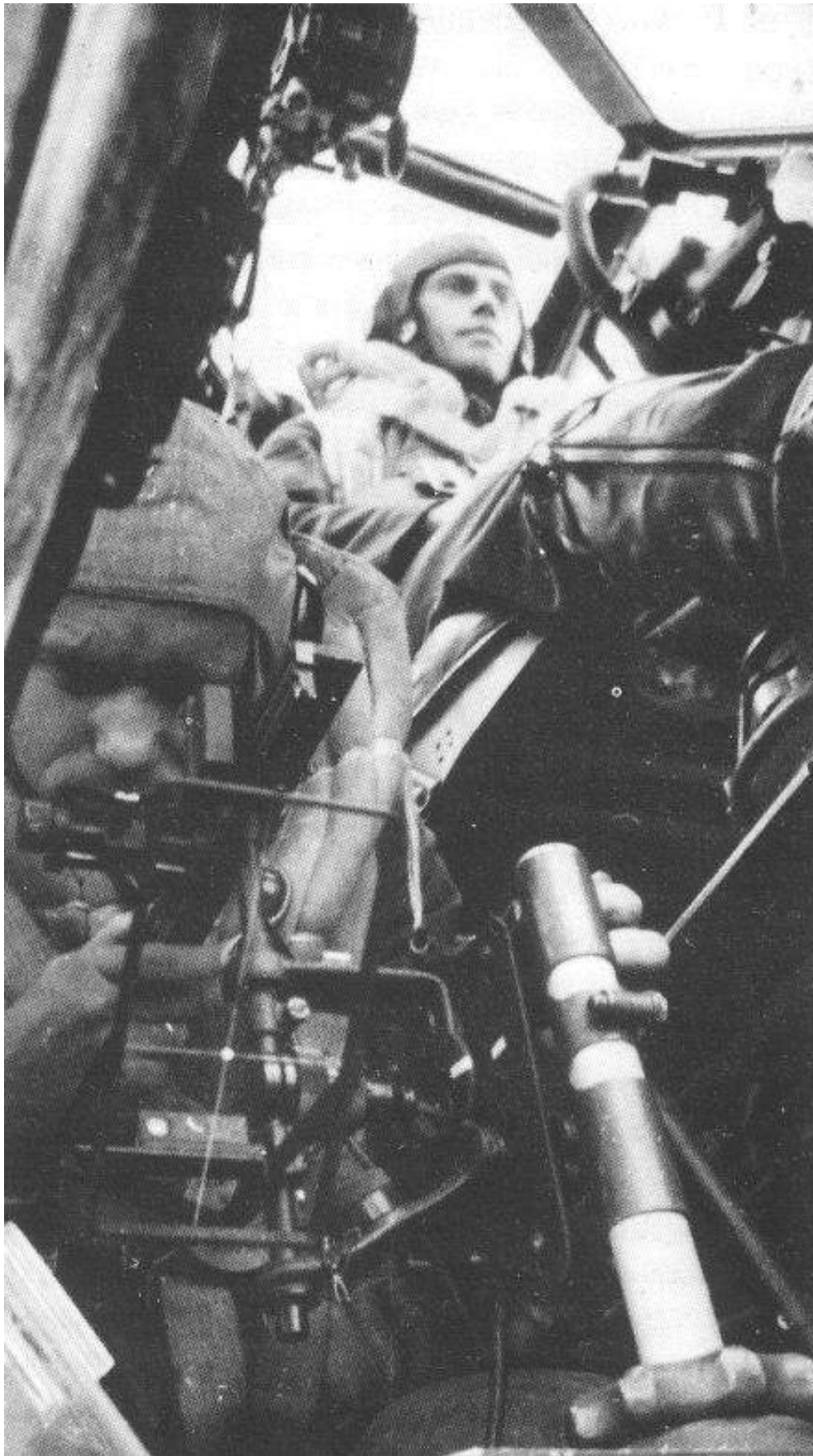
El observador-bombardero de un Do.17 ajusta la puntería de su visor Goerz 6V.219d para localizar el objetivo, presumiblemente próximo.
