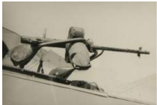
Puesto del observador/bombardero de un Heinkel He.45 y detalle de su ametralladora MG. 15; destaca la bolsa para la recogida de las vainas vacías de los cartuchos disparados
