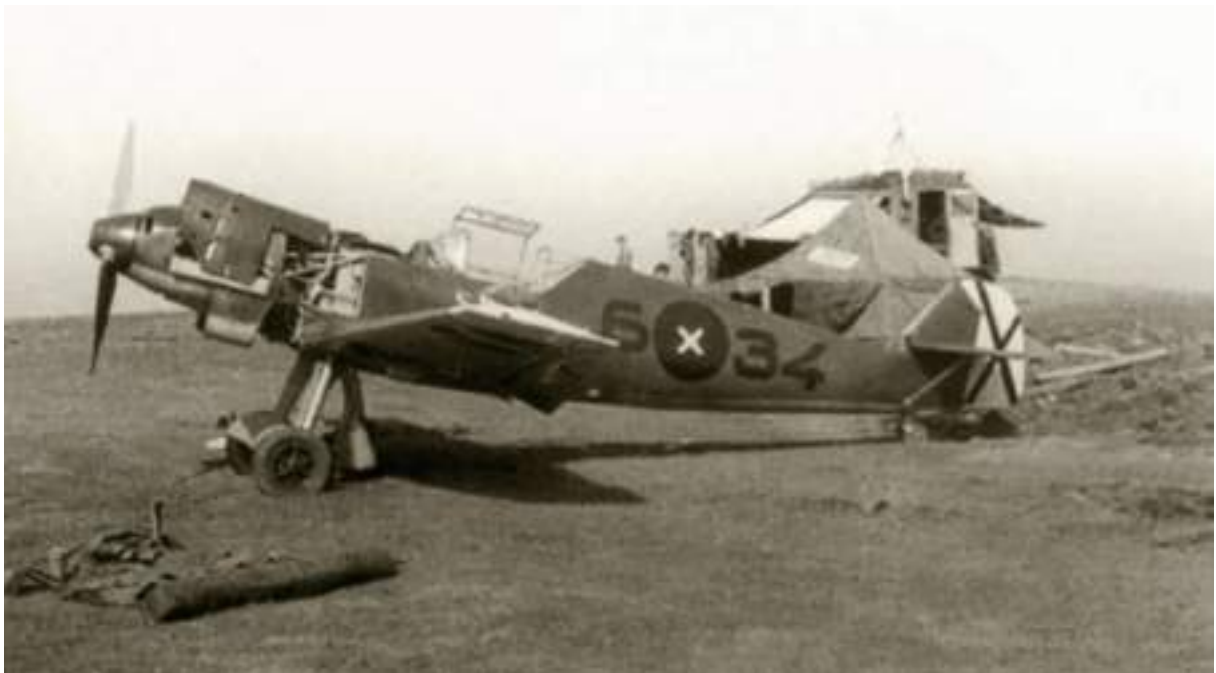
Bf.109 B1 matrícula 6-34 (ejemplar característico de la serie “Bruno/Berta”) con su hélice metálica de paso variable tipo Hamilton. El aparato se encuentra aparcado en el aeródromo de Cué, próximo al mismo remolque de asistencia provisional que se ve a la derecha en la foto anterior. (Ver, asimismo, la foto siguiente)
