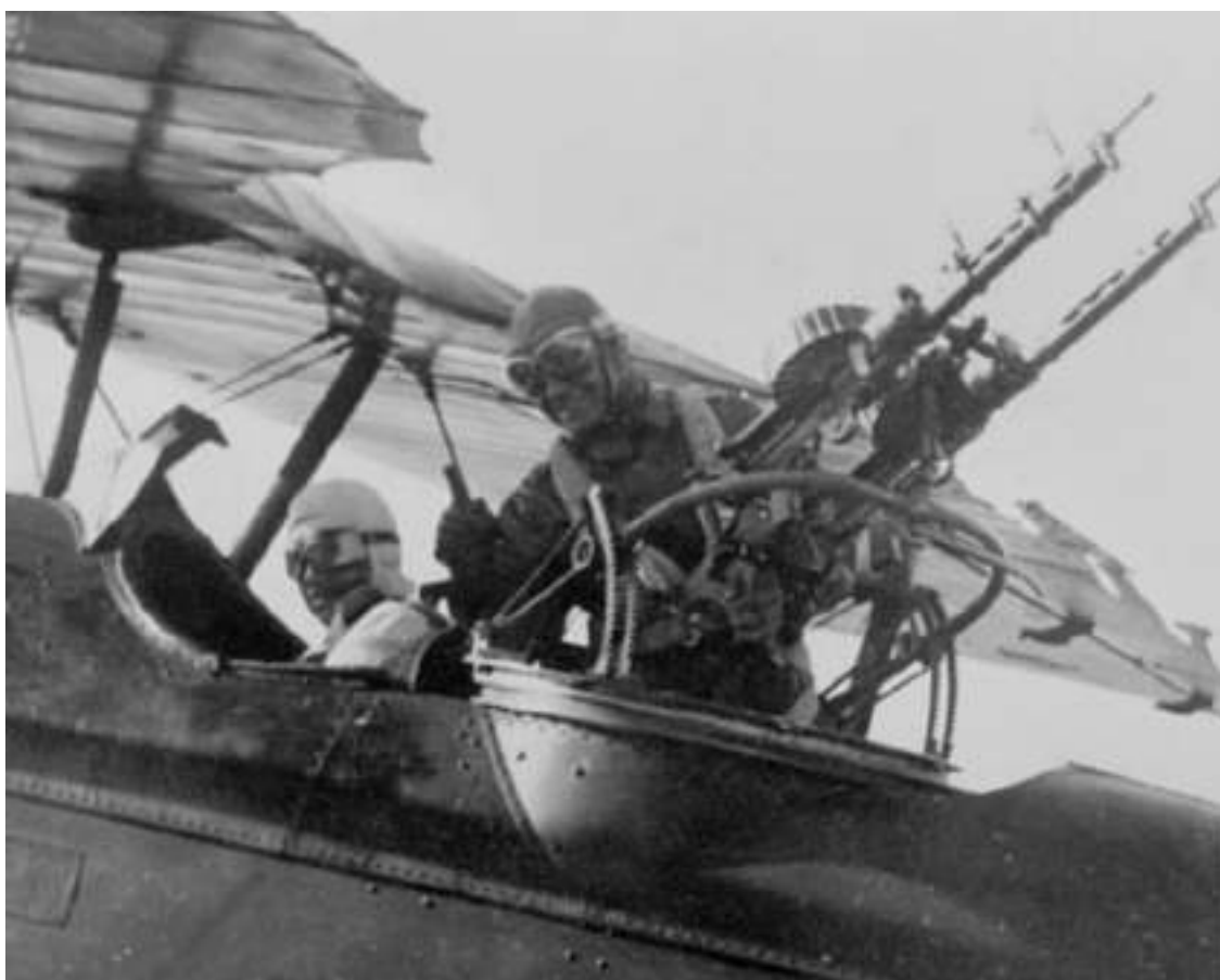
Puesto del observador bombardero de un Potez 25 armado con dos ametralladoras Lewis de 7,7 mm (.303 British) sobre anillo Scarff.
