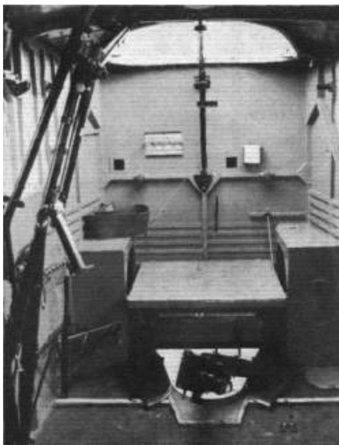
Puestos defensivos superior e inferior del DH.89 M. El primero con el estribo plegable para el tirador bajado y sin la ametralladora; el segundo, con una Vickers Clase “F”.
