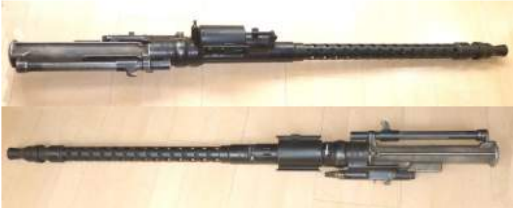
Ametralladora MG. 17 de morro, calibre 7.92 mm (8x57 Mauser) de la que una pareja constituía el armamento del Heinkel He.51
