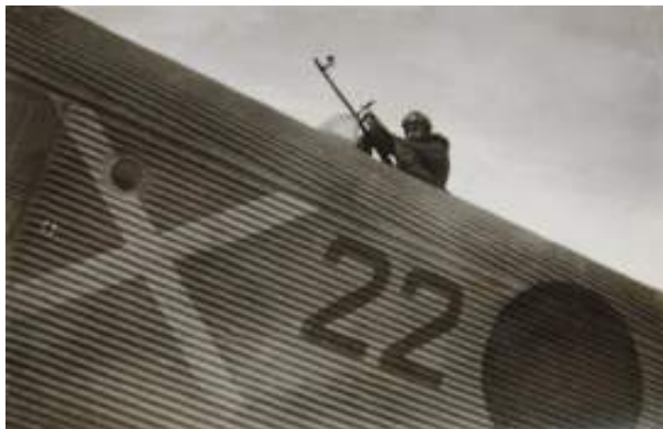
Puesto dorsal de un Ju.52 en el que se aprecia la elevación que se debía dar a la ametralladora para disparar hacia adelante
