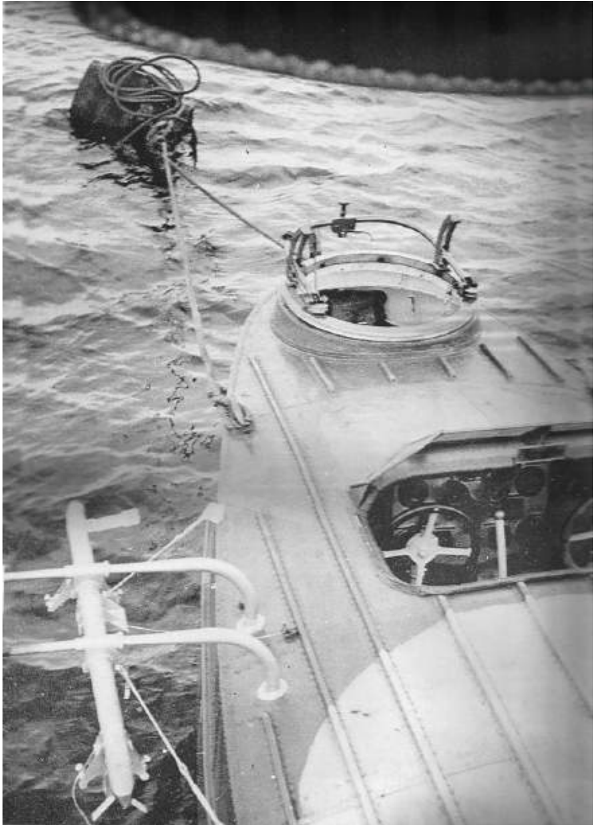
Primer plano de la proa de un Dornier Wal. A destacar el puesto doble de pilotaje, la torreta de ametralladoras proel, con el anillo Scarff, y el soporte para cargas de profundidad de babor.
