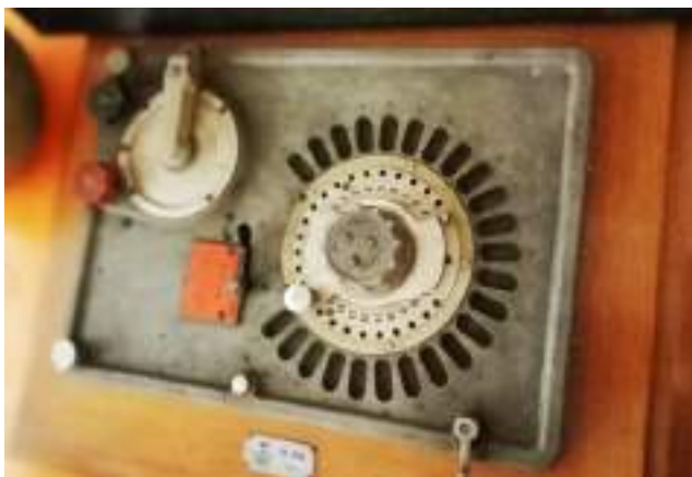
Secuenciador eléctrico de bombardeo RA (Reihen-Abwurf-Automat). Adviértase que ve graduado para 24 bombas (de 50 kg.); o sea, para seis pozos de bombardeo (Colección del Museo de El Cuetu.
