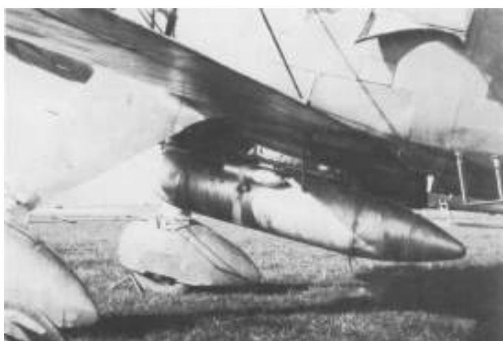
Depósito de combustible suplementario lanzable de un He.51 al que se ha sujetado con una cinta una pequeña bomba explosiva para transformarlo en el “temible” lanzallamas aéreo. En definitiva, una chapuza para tratar de prolongar la vida operativa del He.51
