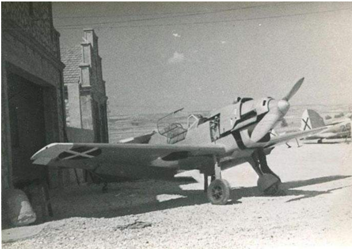
Bf.109A “Anton” –adviértase la hélice de madera– en trance de revisión rutinaria, al aire libre, en el aeródromo leonés.
