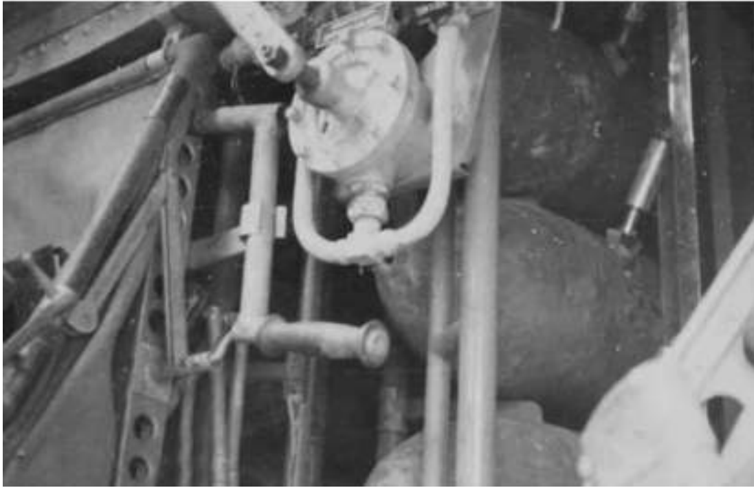
Imagen tomada desde el interior de un Do.17 del lanzabombas Maga 5.C-50, cargado con bombas de 50 kilogramos.
