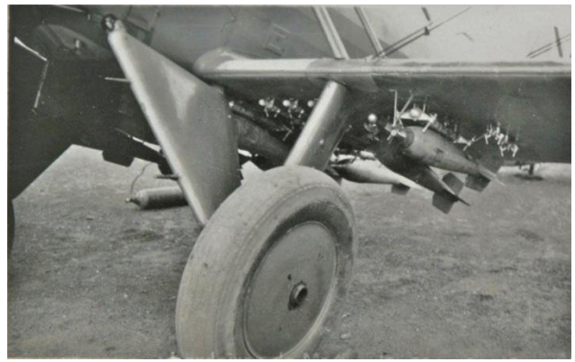
Ab.101 "Praga" cargado con bombas Hispania A.6 de 50 kilos y detalle de la estiba de las mismas.
