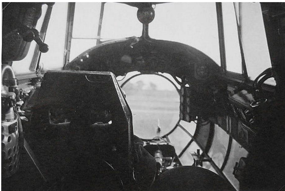
Ametralladora de proa de un Do.17 E-1 en montaje semirrígido. A la derecha de ella, algo retrasado, se ve el visor de bombardeo Goerz Vizier 6V.219d que montaban los primeros bombarderos Do.17 E-1 llegados a España
