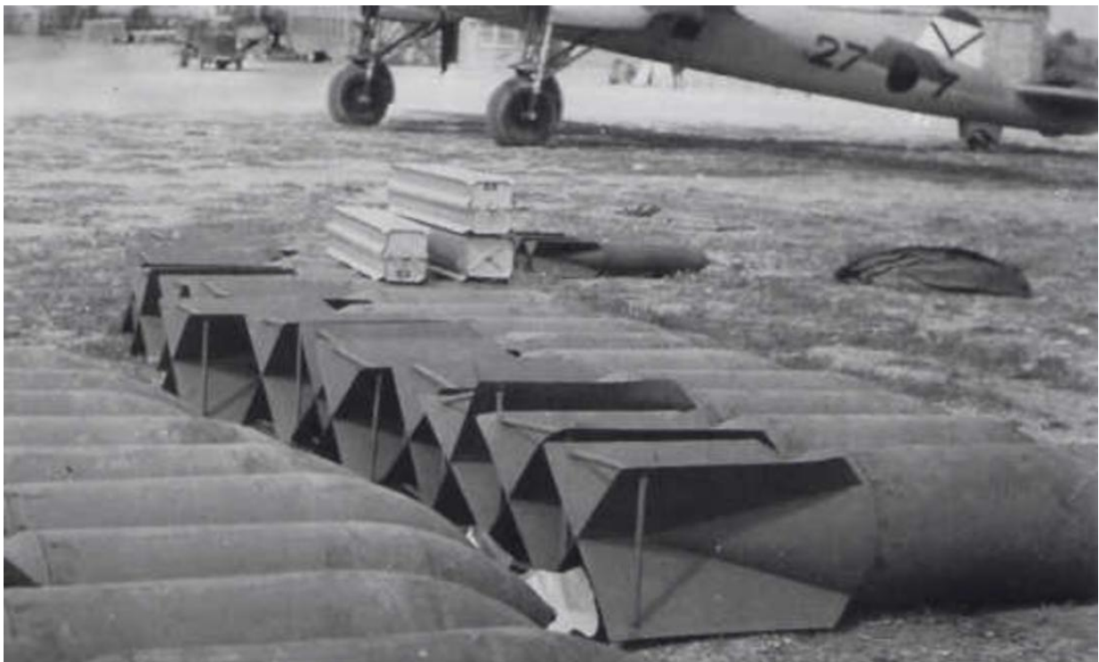
El 27-7 fotografiado ante los diferentes tipos de bombas que podía llevar; SC/50, de 50 kilos; SC/10 de 10 kilos y contenedores para bombas B 1 E de un kilo.
