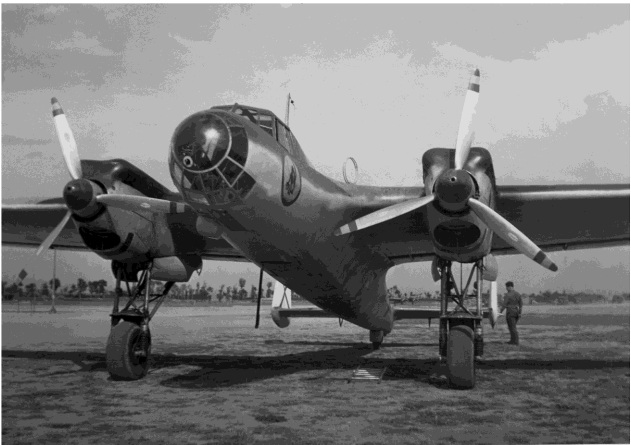
El Do.17 E-1 27-7 –“Gato Erizado” – nos muestra desde el exterior el emplazamiento de la ametralladora de proa. Obsérvese que la boca del arma apenas sobresale de la cristalera del morro.
