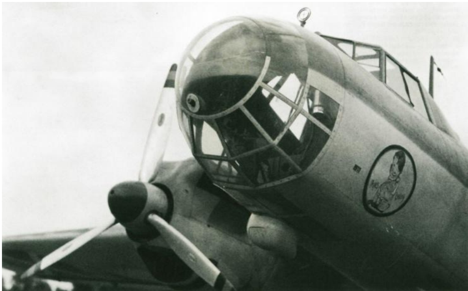
Vista externa del emplazamiento de la MG.15 de proa sobre montaje fijo. El avión es el 27-24 –“Papa’s Liebling” –, uno de los últimos Do.17 E-1 llegados a España.
