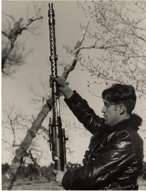
Ametralladora MG.17 de 7,92 mm (8x57 Mauser). Por aquel entonces la ametralladora estándar de los Bf.109 como arma de capot sincronizada con la hélice.
