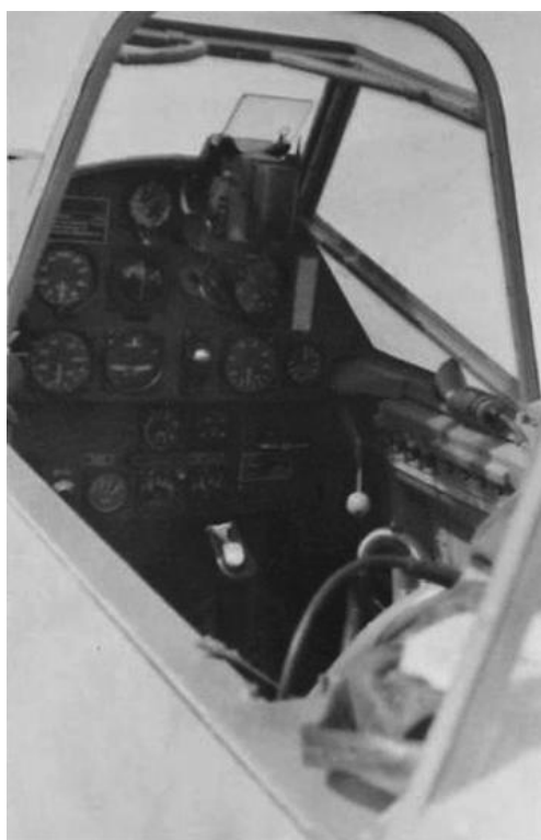
(Izda.) Cabina de un Bf.109 B-1 en la que destaca el visor réflex Revi C/12C. (Dcha.) Detalle de un ejemplar de este visor conservado en el Museo de la Academia Básica del Aire, en León
