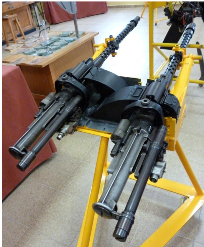
Dos ametralladoras MG.17 expuestas en la posición en que iban colocadas sobre el morro del avión, adviértanse los depósitos de las cintas y las tolvas de expulsión de las vainas vacías. (Foto Museo de la Academia Básica del Aire, León)
