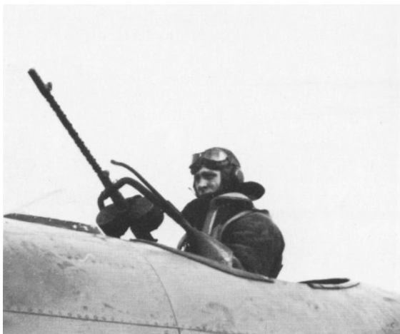
Puesto defensivo dorsal armado con una ametralladora MG.15 de 7,92 mm. En la foto de la derecha se aprecia –a la izquierda– el pequeño parabrisas que protegía al ametrallador.
