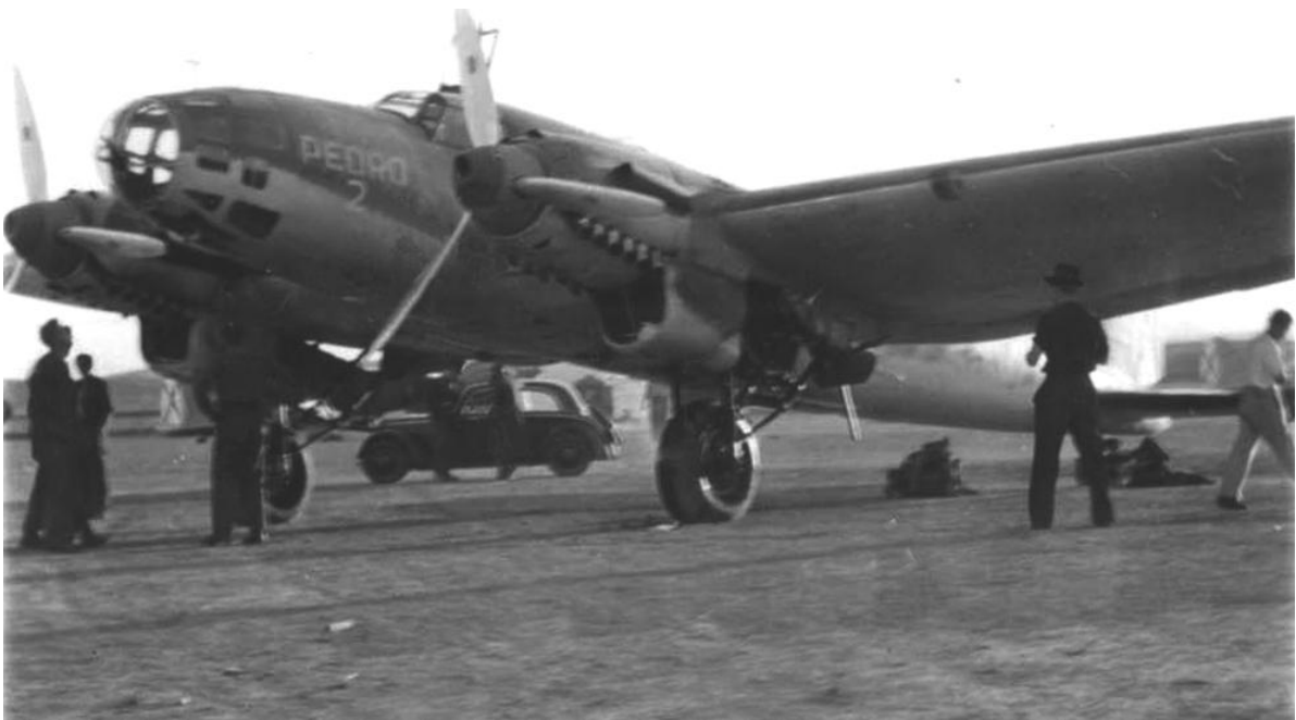
“Pedro 1” 25-3 (arriba) y “Pedro 2” 25-1 (abajo) mostrando las tomas de aire suplementarias de sus motores, el montaje de la ametralladora de proa semicircular y la ventilación del carburador larga, características externas de los Heinkel He.111 B-0
