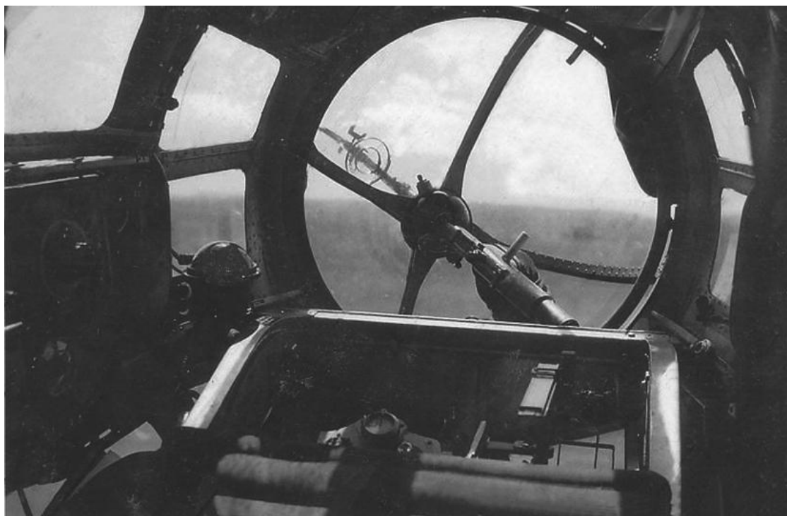
Heinkel He.111 B1 equipado con montaje de ametralladora GD-A 114, de Ikaria Werke y un visor de bombardeo mecánico Goerz Vizier 6V.219d.
