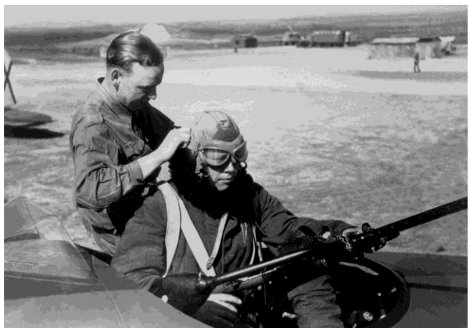
Puesto defensivo dorsal armado con una ametralladora MG.15 de 7,92 mm. En la foto de la derecha se aprecia –a la izquierda– el pequeño parabrisas que protegía al ametrallador.
