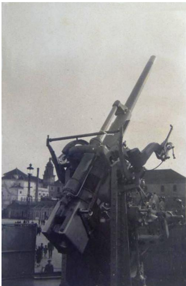
Cañón a/a. Vickers de 76,2/45 Mk. S.S. artillado en el "José Luis Díez" y en los submarinos Clase "C"
