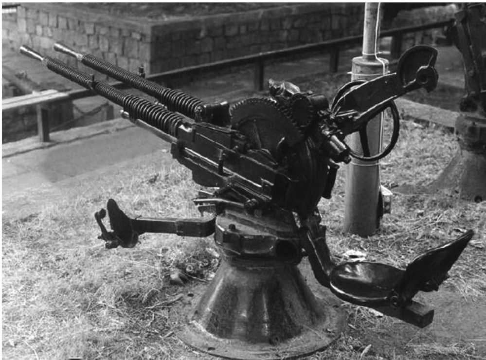
Montaje a/a. doble Hotchkiss de 13,2 mm del tipo que artillaba el “Císcar”.
