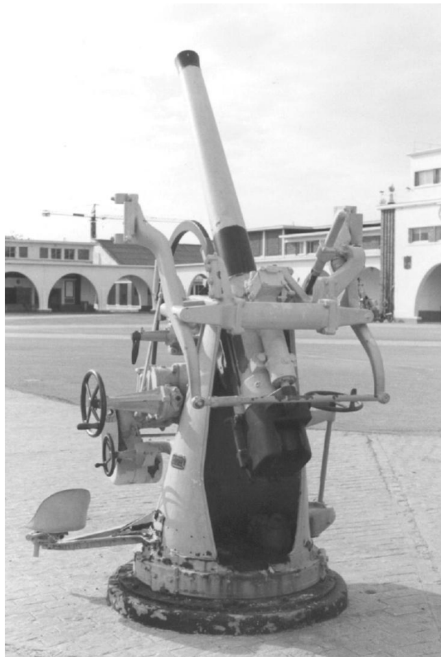
El cañón a/a de 76,2/4 Mk. F.F. que montaba en "Císcar" era más antiguo y de peores características que el Mk. S.S.
