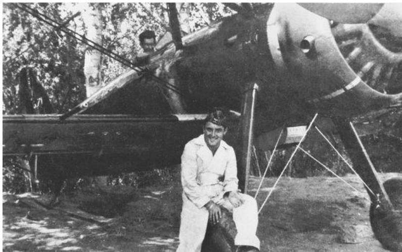
Letov S. 231 de la 71ª Escuadrilla, en la zona de Levante. Adviértase la ametralladora del plano inferior izquierdo; pueden verse igualmente los enganches para los lanzabombas de ese mismo plano.
