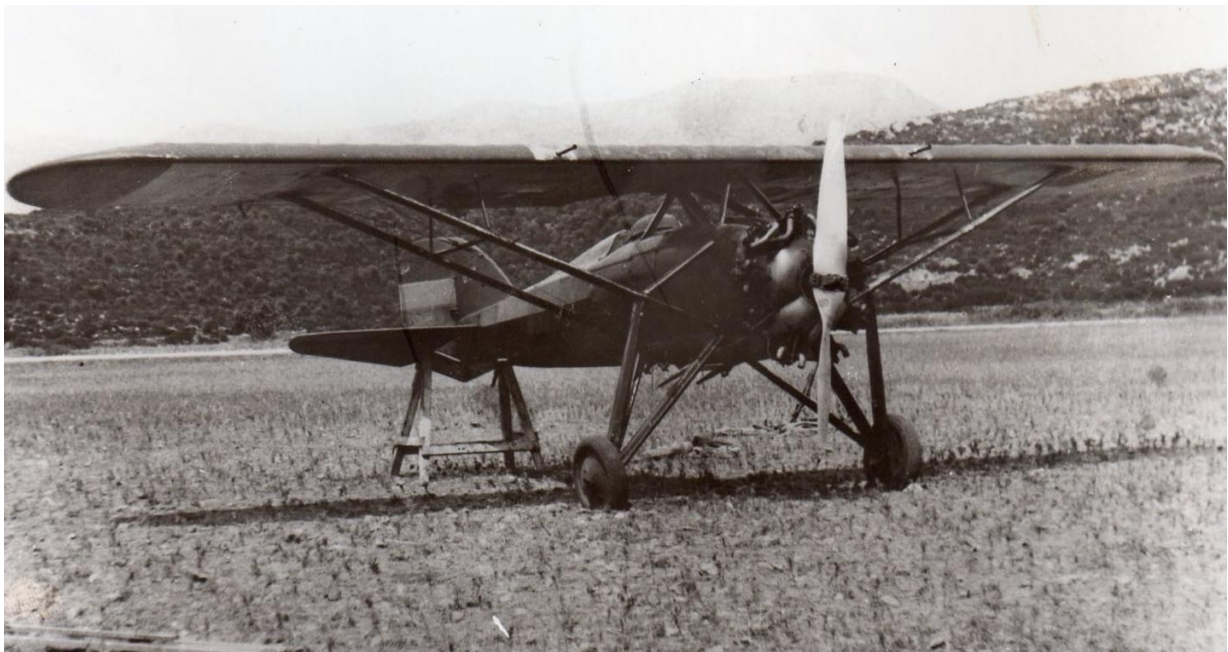
Gourdou-Leseurre de última fabricación, derivado del GL.432. Se aprecian las dos ametralladoras en el ala y el lanzabombas ventral.
