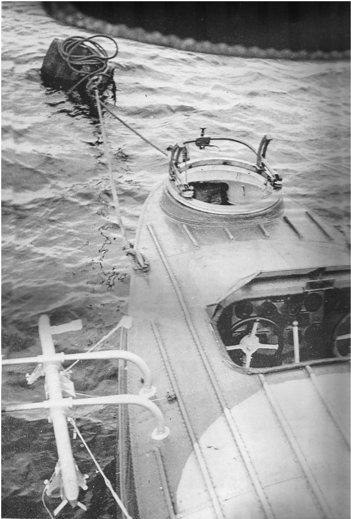
.Primer plano de la proa de un Dornier Wal. A destacar el puesto doble de pilotaje, la torreta de ametralladoras proel, con el anillo Scarff, y el soporte para cargas de profundidad de babor
