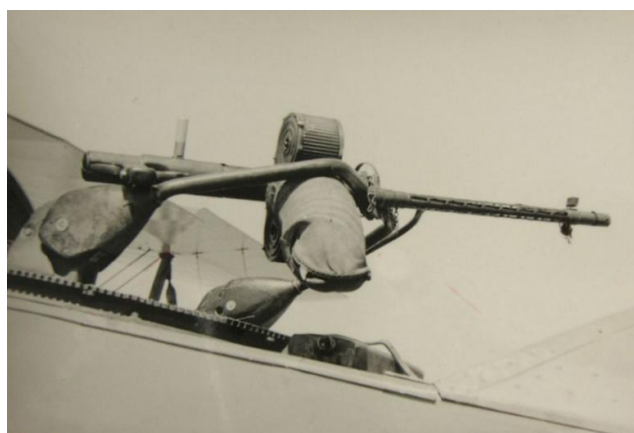
Puesto del observador/bombardero de un Heinkel He.45 y detalle de su ametralladora MG. 15.
