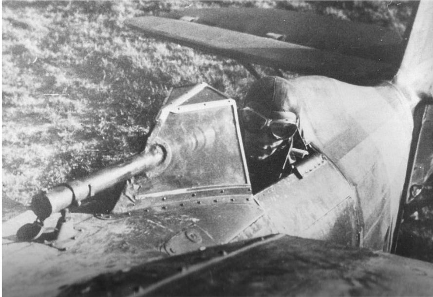
Detalle del visor de puntería OP-1 (licencia Goerz) que montaban los I.15
