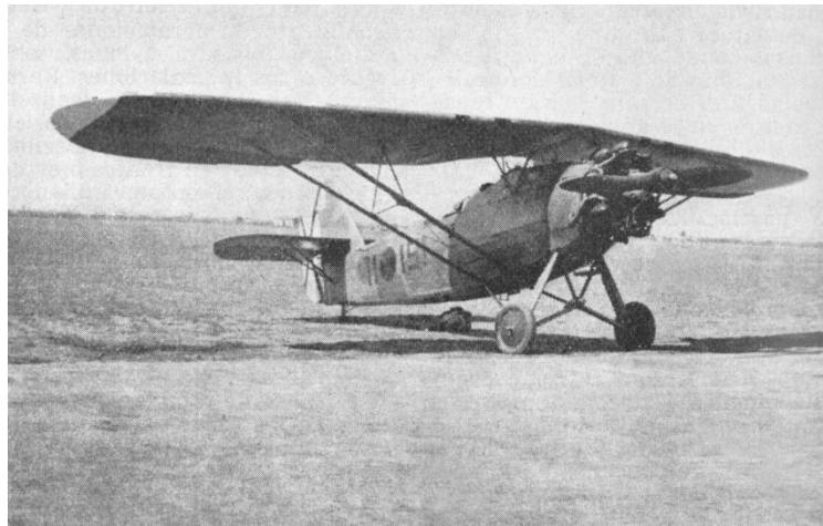
Heinkel He.46 C-1, con matrícula 11-151 (la más baja de las asignadas a las “Pavas” tripuladas por españoles) de reconocimiento cercano y pequeño bombardeo.
