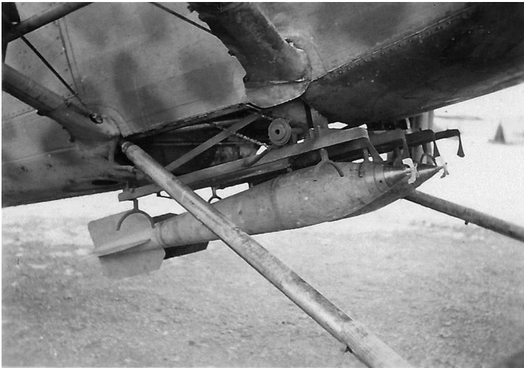
Detalle del lanzabombas 4-A-6, con las dos bombas de 50 kilos en los engarces centrales, si bien estos lanzabombas, como se ha dicho, sólo empezarían a utilizarse ya finalizada la guerra en Asturias.
