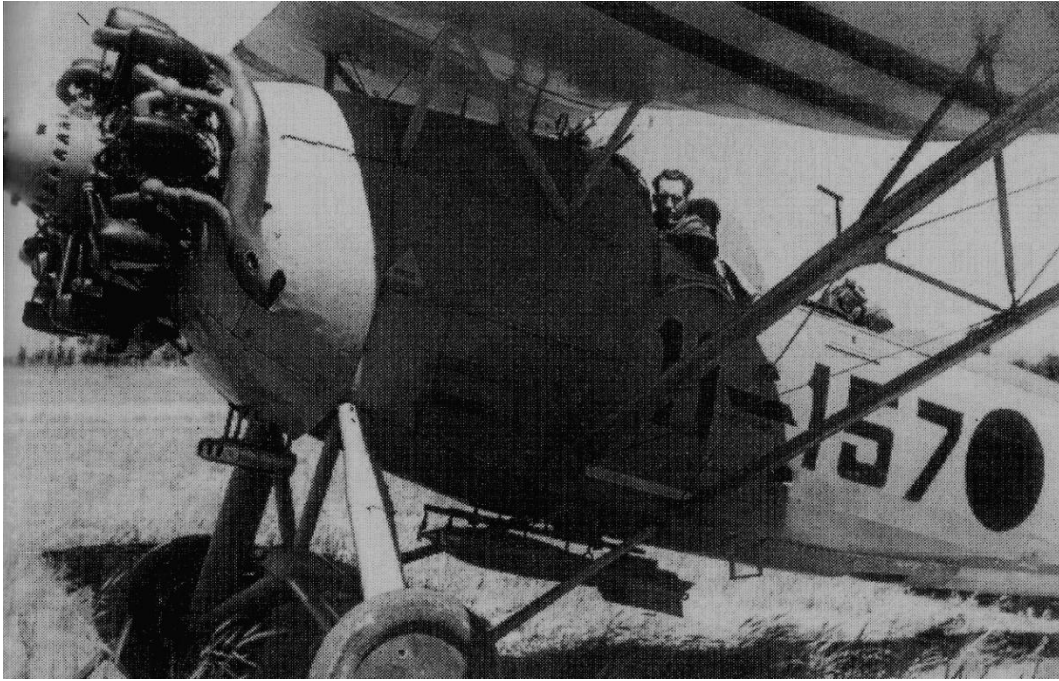
Heinkel He.46 11-157 de la 2ª Escuadrilla, portando las dos bombas Hispania A.6 suplementarias, de 50 kilos.
