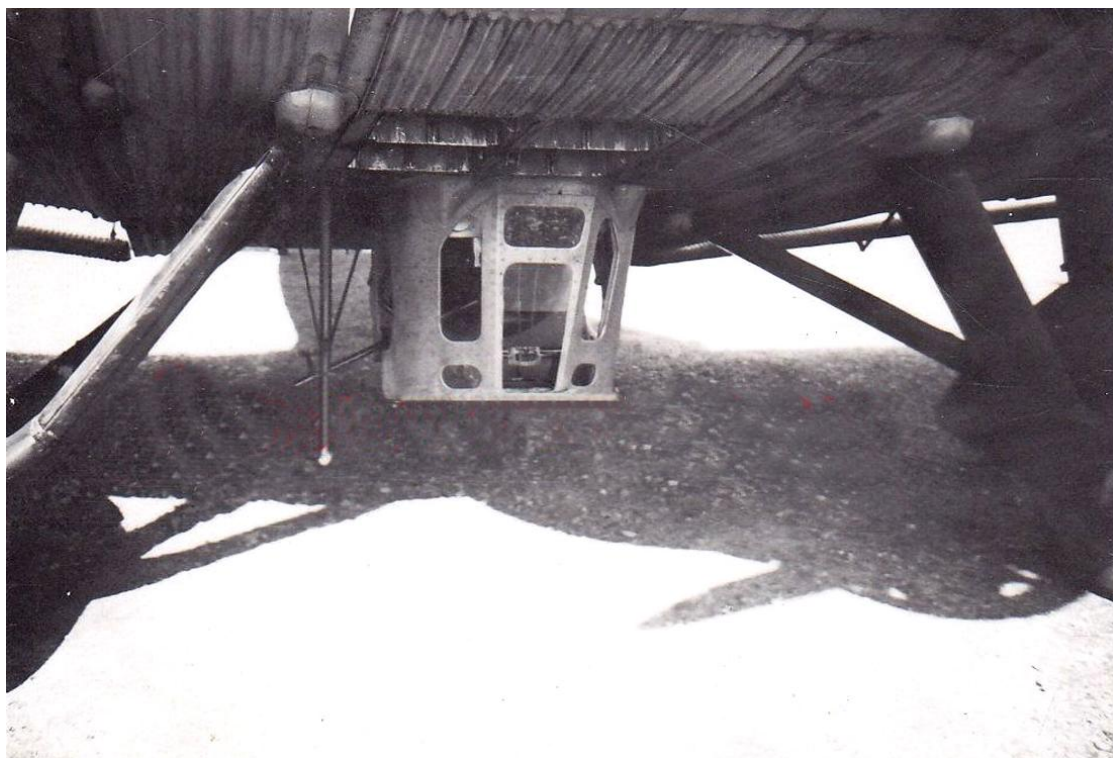
El “cubo” del ametrallador-bombardero de un Ju.52 en su posición de repliegue máximo para poder operar en tierra.
