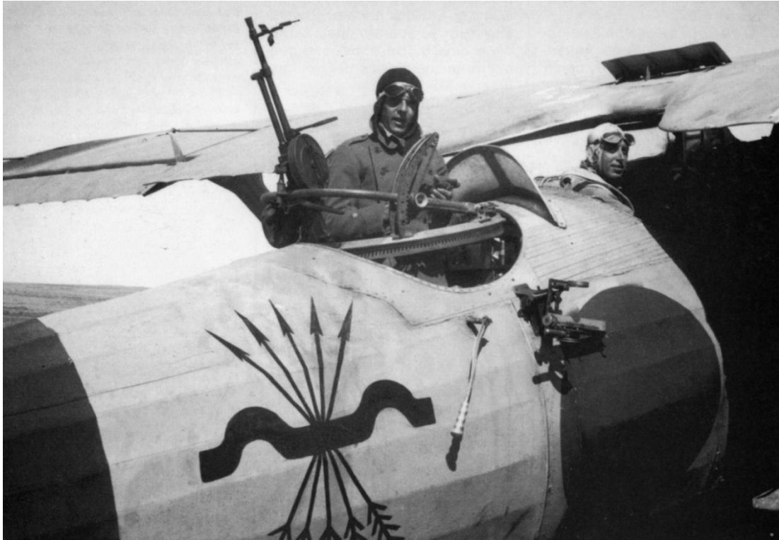
Los Breguet XIX entrarían en la guerra armados con ametralladoras Vickers tipo K (o G.O.) montadas sobre anillos de torreta Scarff y con visores de bombardeo Warleta, que se aprecia en el costado derecho del aparato.
