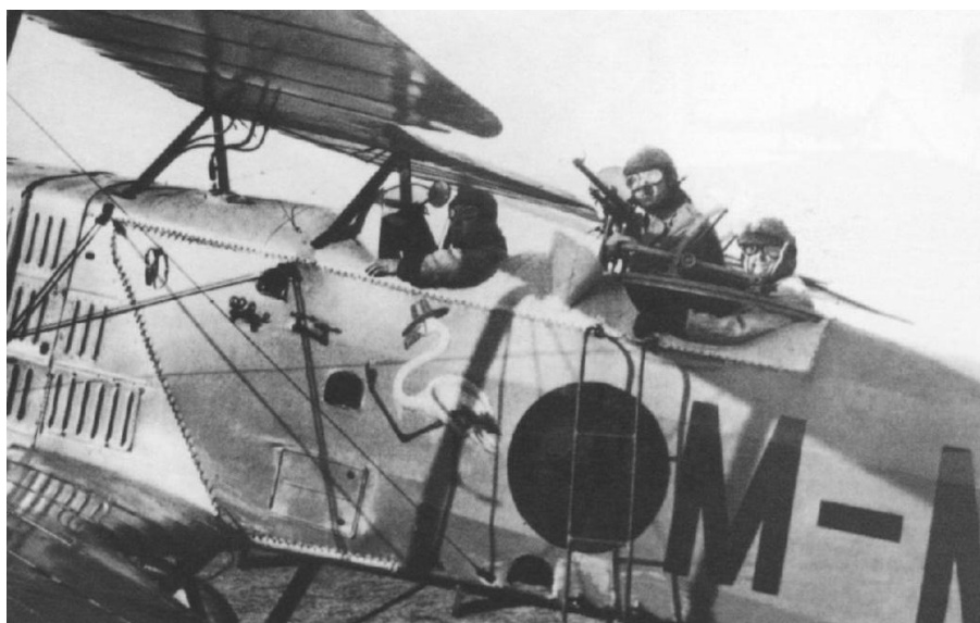
Ametralladora Hotchkiss Ligera de Caballería Mod. 1922 o Mitrailleurse Portative Mod. 1909, según la designación de la firma francesa que la proyectara.
