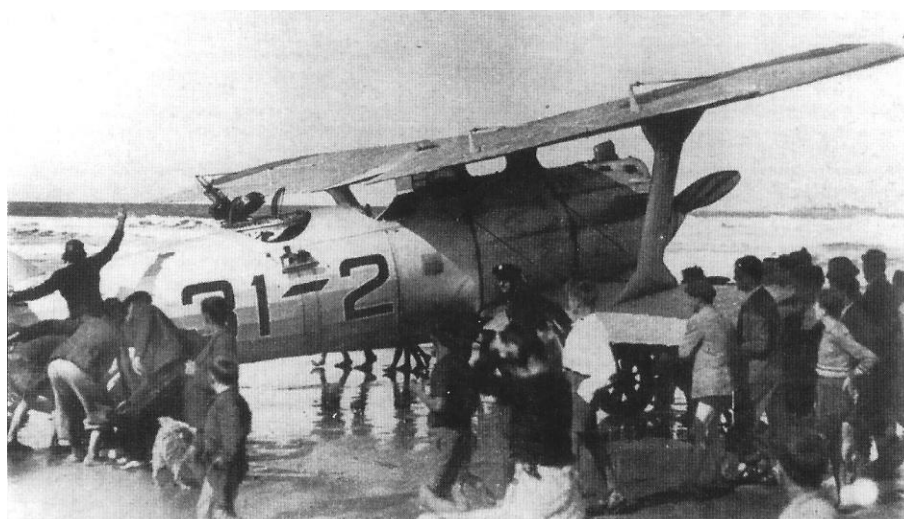
Instantánea del 31-2 tomada inmediatamente a la anterior en la que puede apreciarse el montaje doble de ametralladoras Darne y adivinarse –más que verse– el visor de bombardeo “Warleta” en el costado derecho del fuselaje (sobre el guión).
