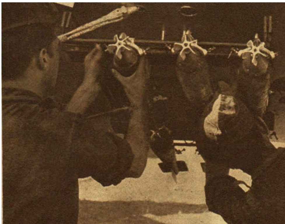
Armeros de Aviación completando en un Breguet XIX la carga ofensiva usada habitualmente sobre Asturias: seis bombas A.5, de 12 kilos, bajo cada uno de los planos inferiores en sus correspondientes lanzabombas 3-A-5
