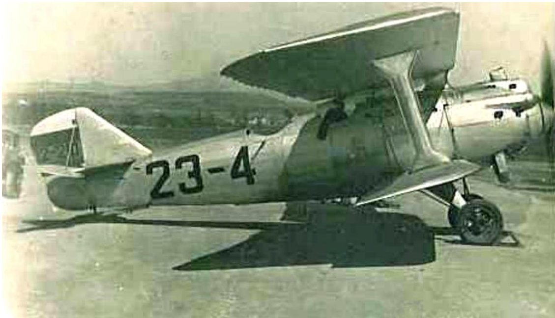
Br XIX construido por CASA con número de fabricación 182 y motor Elizalde A4
