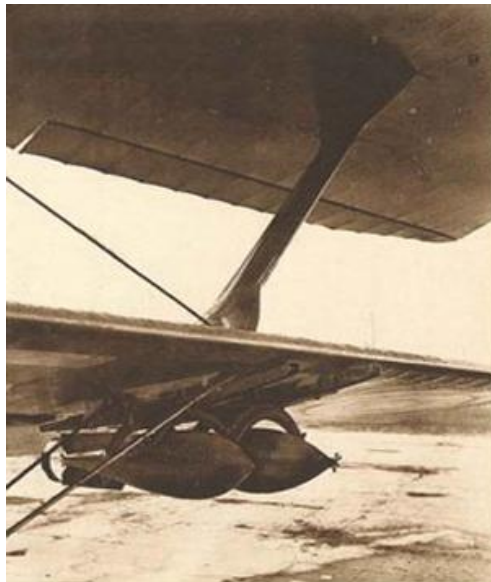
Lanzabombas externos bajo los planos para bombas de 100 kg.
